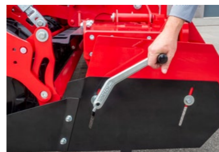
Ajuste de los paneles laterales con la llave universal
