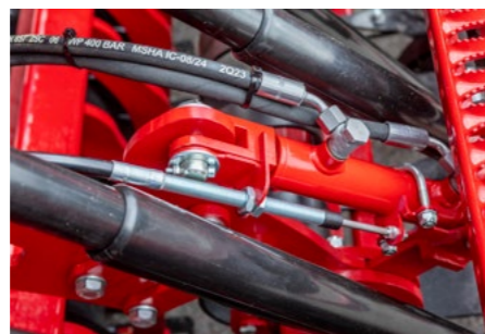
Cilindro hidráulico de ajuste de presión de reja
