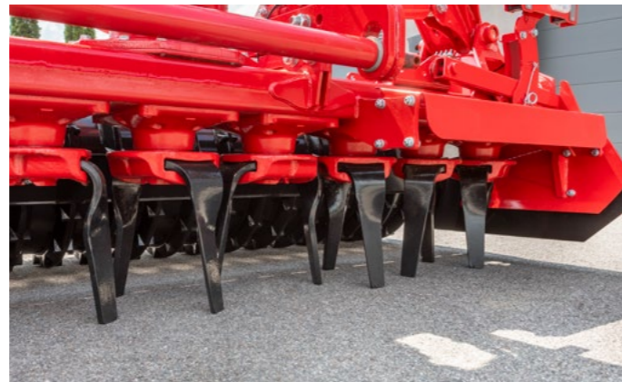
10 rotores para un espacio libre máximo de 3 m de anchura de trabajo
