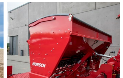
Depósito de 1500 l: menos paradas de llenado gracias al aumento del volumen del tanque.
