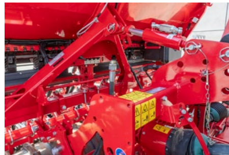
Tercer punto hidráulico entre la grada rotativa y Versa KR
