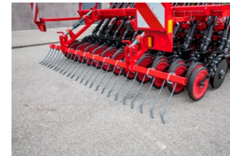
Rastrillo pesado: ideal para siembra tardía en condiciones húmedas
