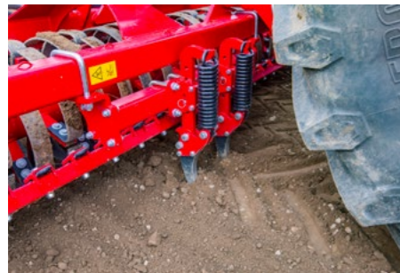
Púas borra-huellas con suspensión de muelles
