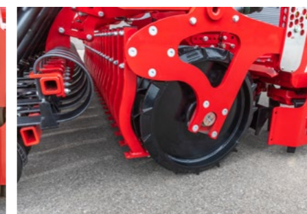
Rodillo de anillos trapezoidales de 60 cm de diámetro
