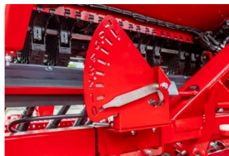
Escala de indicación de la presión de reja ajustable hidráulicamente
