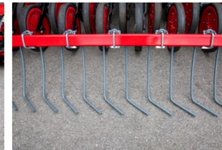
Las púas acodadas aseguran un movimiento transversal de la tierra y cubren de manera segura cada semilla.
