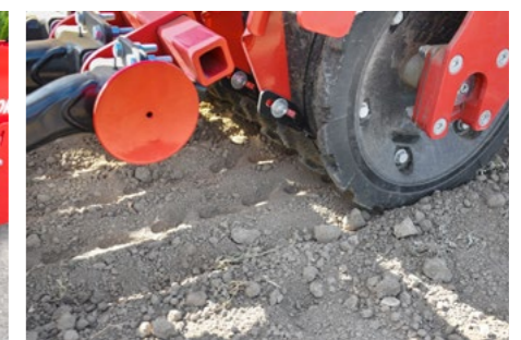
Rodillo FarmFlex Reduce la formación de costras mediante la compactación en franjas.
