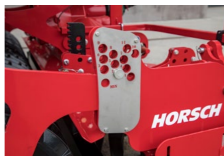
Ajuste de la profundidad de trabajo bien visible de la Versa SL mediante pasadores
