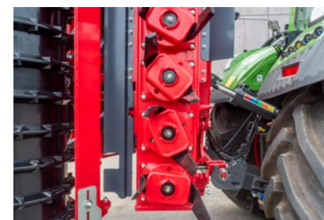
Las púas pueden cambiarse sin herramientas
