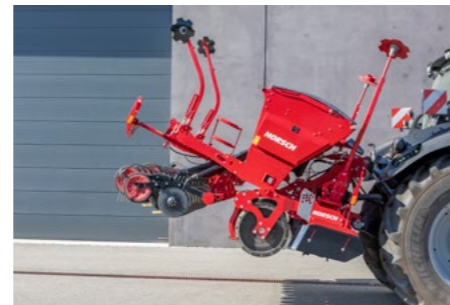
Mayor distancia al suelo durante el transporte por carretera mediante la retracción del cilindro hidráulico.
