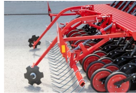
Marcadores de preemergencia ajustables de manera flexible
