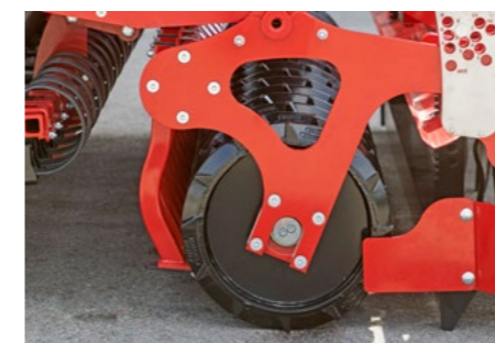
Rodillo de anillos trapezoidal de 50 cm de diámetro
