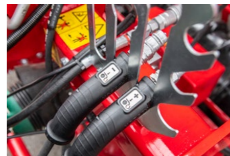
Conectores hidráulicos claramente marcados
