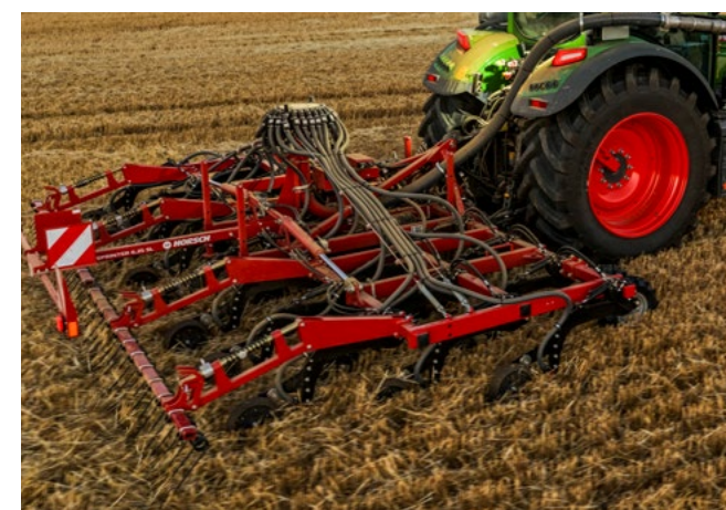
Estructura de 3 vigas para un paso máximo
