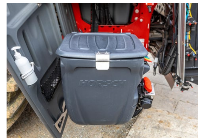
35 l Depósito de aplicación de producto
