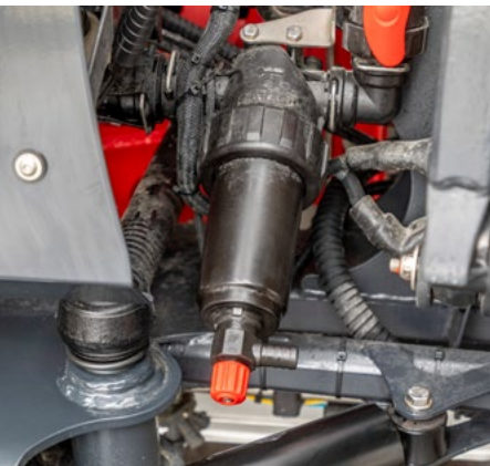
Segundo filtro de presión en el marco central de la estructura
