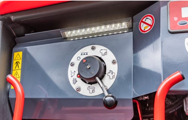
Iluminación bajo el revestimiento: para trabajar de manera segura en la oscuridad
