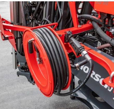
Carrete de manguera para limpieza exterior
