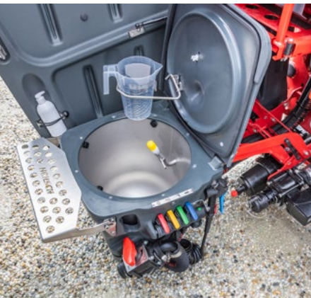
52 l tolva de dosificación de acero inoxidable incl. boquilla de impulso adicional
