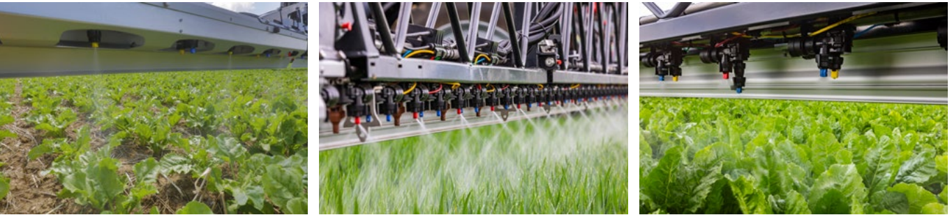
La pulverización en banda tampoco supone un problema con una separación de 25 cm. 25 cm de separación de boquillas: más boquillas, más posibilidades, por ejemplo, aplicación 3D Conmutación de boquillas neumáticas 2-2 con aplicación 3-D
