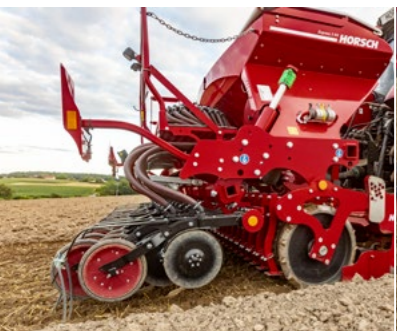
Las rejas de siembra se pueden levantar completamente de forma hidráulica para cultivar, por ejemplo, las cabeceras sin sembrar.
