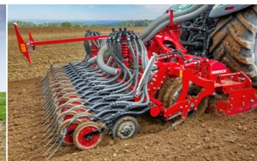
Unidad compacta compuesta por grada rotativa, packer y rejas de siembra para una distribución favorable del peso
