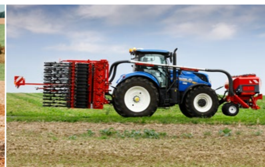
Posición de transporte Plegado hidráulico con una anchura de transporte inferior a 3 metros
