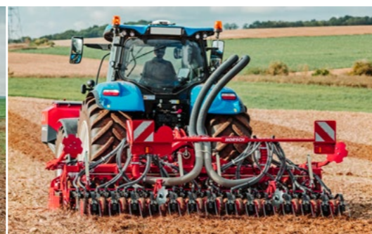
Control eléctrico opcional de media anchura para facilitar el SectionControl en campos irregulares y en las cabeceras
