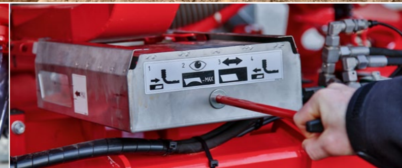
Prueba de calibración segura y sencilla. Se puede manejar desde la parte trasera de la máquina. La tapa de calibración se abre y se cierra automáticamente.
