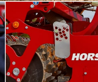
Ajuste sencillo y fácilmente comprensible de la profundidad de trabajo de las gradas rotativas
