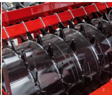
Rodillo compactador de dientes universal con gran diámetro
