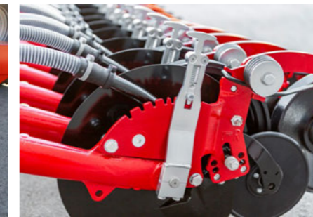
Ajuste individual de profundidad con graduación precisa y sin herramientas
