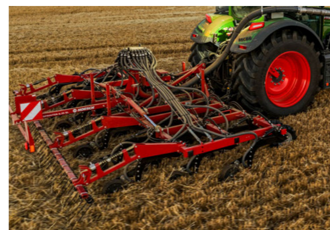
3-řadá konstrukce pro maximální průchodnost
