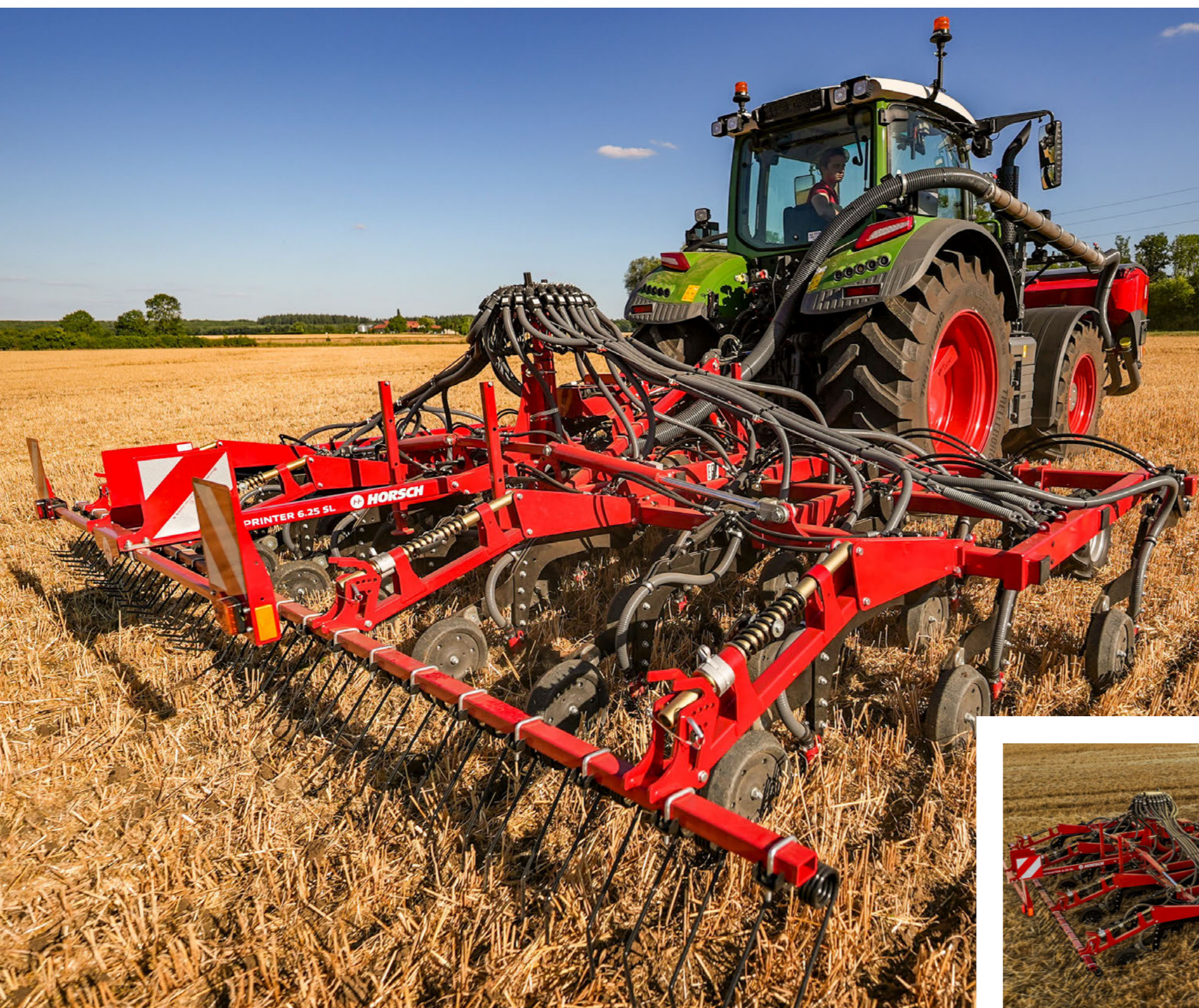
3-řadá konstrukce pro maximální průchodnost
