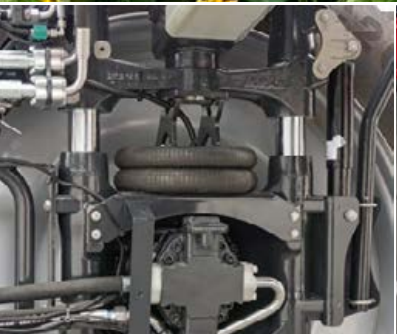
Individuální zavěšení kol na posuvném rámu
