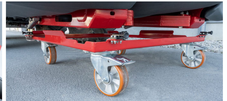
Robustní manipulační vozík usnadňuje manipulaci s čelní nádrží
