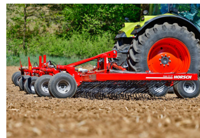
Rama dopasowuje się do podłoża dzięki kołom podporowym
