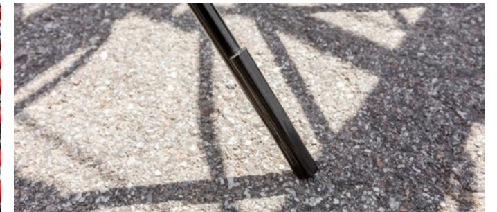
Palce zgrzebla z płytą ochronną z węglików spiekanych na wysokość 60 mm
