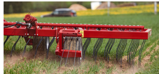
Koła podporowe rozmieszczone z przesunięciem względem siebie, tak aby rośliny nie były dwukrotnie przytłaczane.
