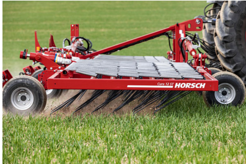
Hydrauliczne napięcie zębów z podwójną sprężyną
