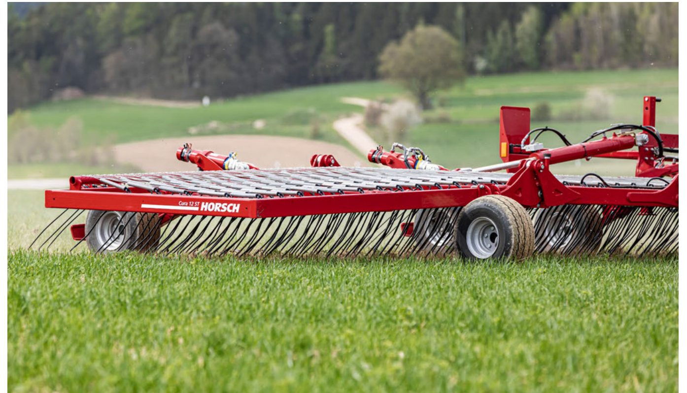
Seryjnie zabudowane koła podporowe umieszczone z przodu i z tyłu
