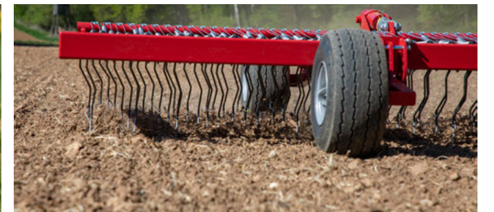
Koła podporowe umieszczone w jednej koleinie, tak aby np. w uprawach rzędowych jechały w tym samym śladzie.
