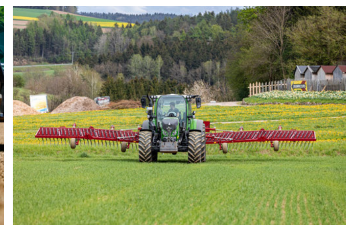
Ustawienie do pracy na uwrociu zapewnia więcej prześwitu w momencie skrętu
