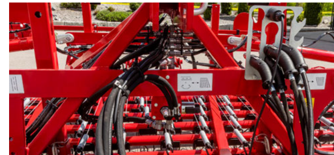
Opcjonalny zawór elektromagnetyczny oszczędza jeden sterownik i jest chroniony przez położenie między punktami sprzęgania zgrzebla
