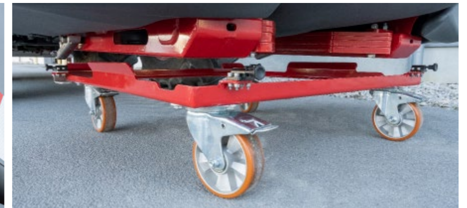
Odporny wózek manewrowy ułatwiający obsługę zbiornika czołowego
