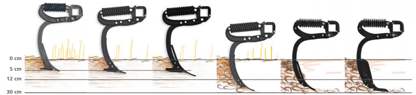
Redlica skrzydełkowa TerraCut Skrzydła redlicy MulchMix do płytkiej pracy Głęboko pracujące skrzydła redlicy MulchMix MulchMix bez skrzydeł Redlica LD Redlica ULD
