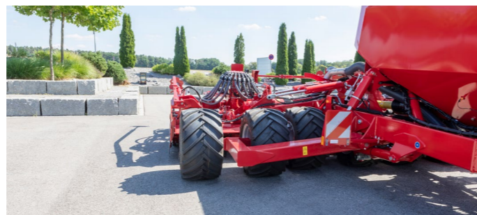
Równomierne wtórne zagęszczenie przed broną wirnikową
