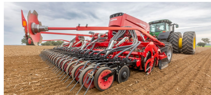
Redlice TurboDisc trzeciej generacji gwarantują precyzyjne umieszczenie nasion w glebie
