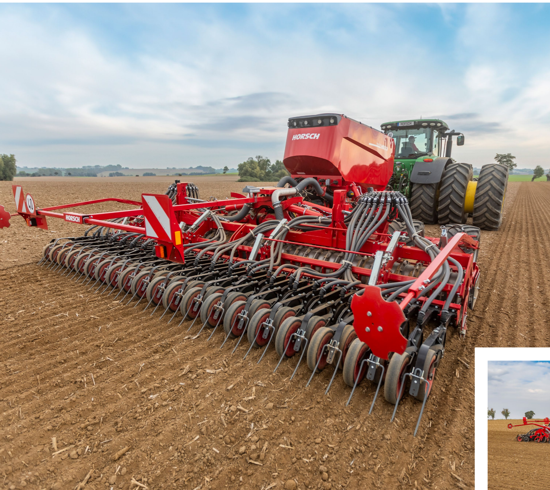
Maksymalna wydajność dzięki podwójnemu zbiornikowi GGf o pojemności 5000 l
