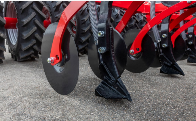
Redlica siewna WideEdge tworzy pas siewny o szerokości 7 cm
