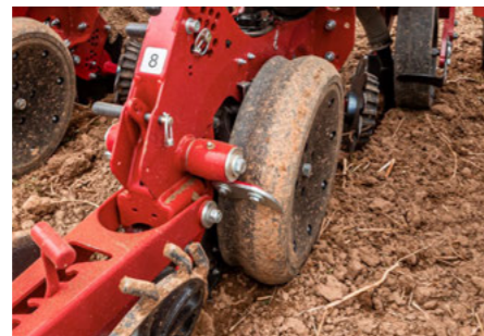
Kółko RID zmniejsza ugniatanie gleby bezpośrednio przy szczelinie siewnej w bardzo trudnych warunkach lub w siewie bezpośrednim
