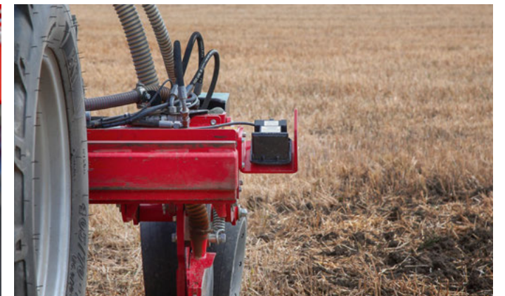
Jeden z dodatkowych czujników radarowych dla ContourFarming
