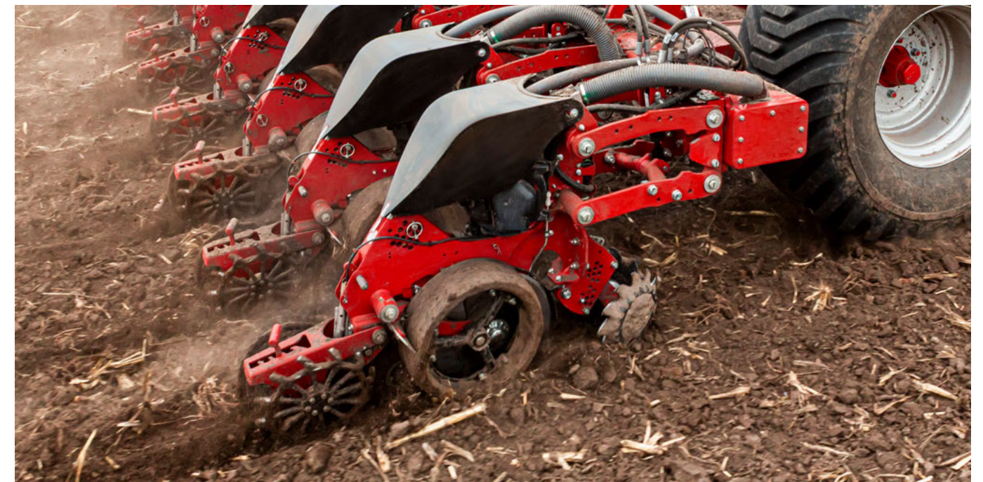
Masywna sekcja wysiewająca w Maestro
