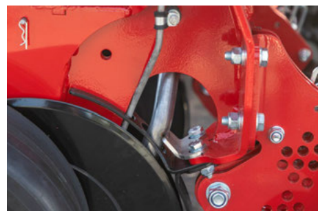
Aplikacja nawozu płynnego w rzędzie
