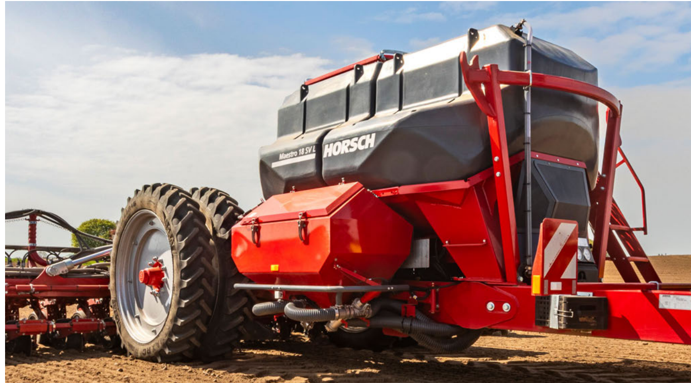
Jednostka do wysiewu mikrogranulek W celu napełnienia i lepszego dostępu do maszyny zbiornik można odchylić do przodu
