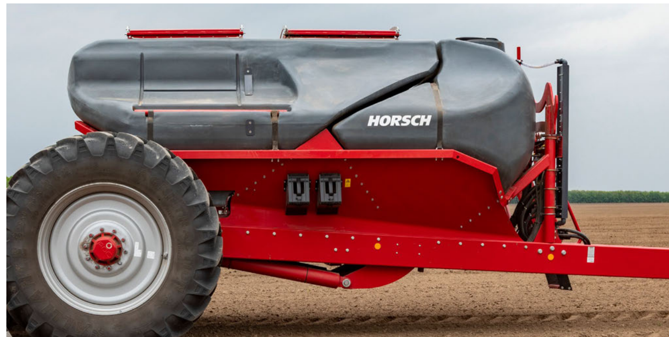
Zbiornik MTS o pojemności 800 l
