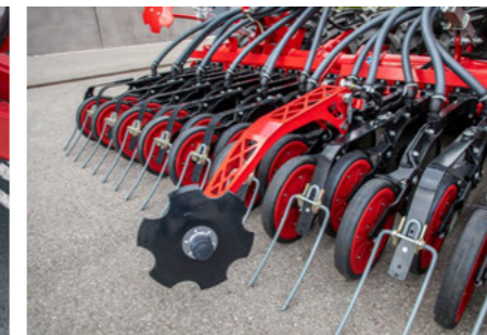
A vetőgép kelés előtti nyomjelzőjének agresszivitását egy ütközővel állítják be.
