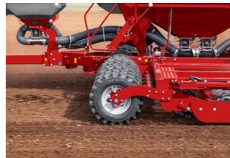
A traktor lehető legcsekélyebb tömörítése a keréknyomban a magágyban
