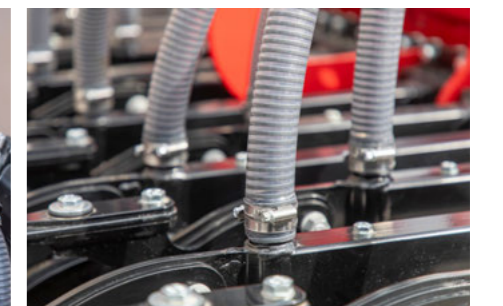
Optimalizált pneumatikus csövezés és lejtéssel szerelt vetőcsövek
