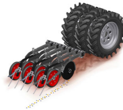
Duplatartály Gabona és Műtrágya – két komponens közös elhelyezése a TurboDisc vetőcsorozlyán keresztül
