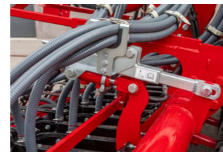
A traktor vezérlőegységén keresztül növelhető a csorozlyanyomás.
