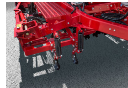
Rugózott nyomlazító kapák a traktor nyomában lévő talajtömörödések lazítására szolgálnak.
