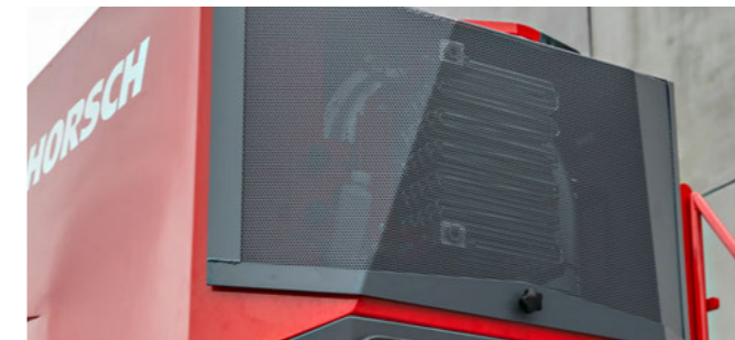
Olajhűtés a hidraulikus ventilátoron – felmelegíti a légáramot a pneumatikus rendszerben
