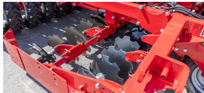
DiscSystem állítható nyomlazító tárcsákkal
