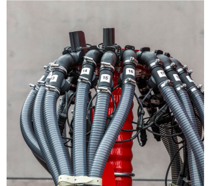
Műtrágya- és vetőmagáramlás-ellenőrzés – a vető- és műtrágyacsövek folyamatos felügyeletéhez
