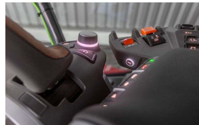
Biztonságos kezelés az A-oszlop kijelzőjén: Forgó-nyomógombokkal
