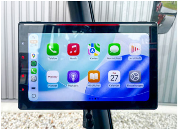
Nagyfelbontású, automatikus tolatókamerakép megjelenítés az A-oszlop kijelzőjén
