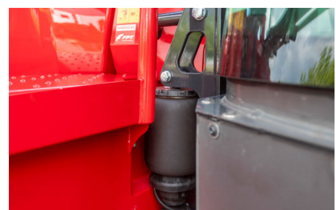
Pneumatikus 4-pontos kabinrugózás
