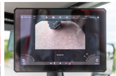
Nagyfelbontású, egyedi megjelenítés a nyom figyelő kameráról az A-oszlop kijelzőjén
