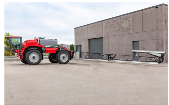
Opcionális: Hidraulikus szórókeret csökkentés 17/36 (m) 30 m-re
