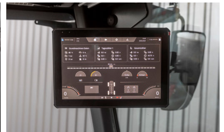
Szériefelszereltségű 12"-os A-oszlop kijelző szabadon konfigurálható megjelenítéssel
