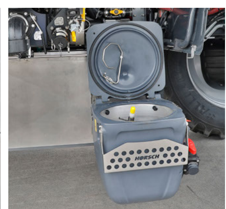
52 l rozsdamentes acél vegyszerbekeverő, beleértve a kiegészítő sugárfűvókát
