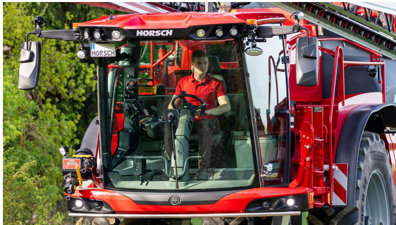
Fülke nagy üvegfelületekkel az optimális körkörös kilátás érdekében
