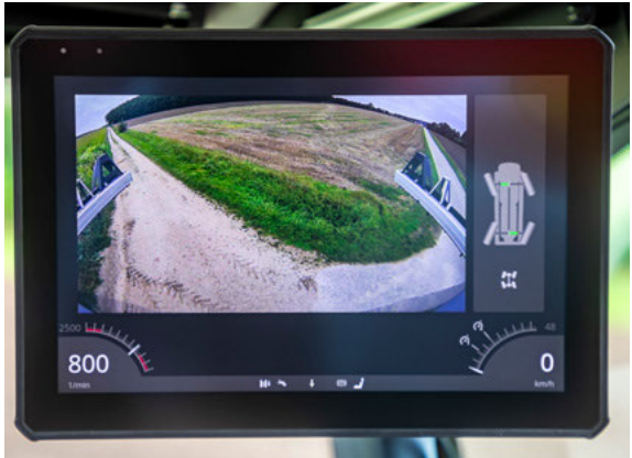
Nagyfelbontású, automatikus tolatókamerakép megjelenítés az A-oszlop kijelzőjén
