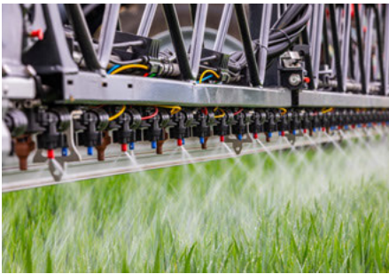
25 cm-es fúvókaosztás: több fúvóka, több lehetőség, pl. 3D kijuttatás
