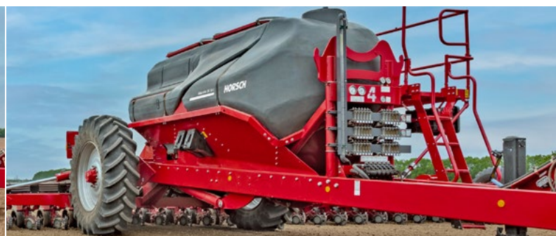
A folyékony műtrágya tartály szintjelzője és RedBall áramlásjelzője
