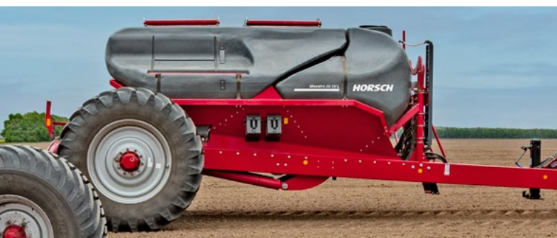
Vetőkocsi 5 000 liter vetőmaggal és 3 900 liter folyékony műtrágyával a maximális hatékonyság érdekében.
