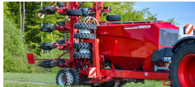
Hydraulisch vorgespannter Seitenpacker – Transportstellung
