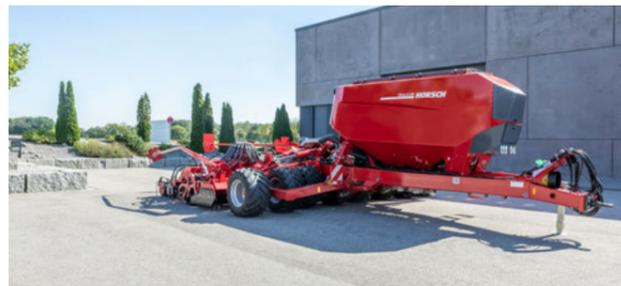
Die Breitreifen reduzieren tiefe Fahrspuren durch eine optimale Gewichtsübertragung der Versa SW
