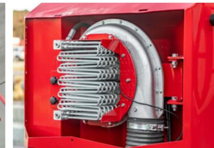
Senkt die Öltemperatur im System und entlastet den Ölkühler des Traktors
