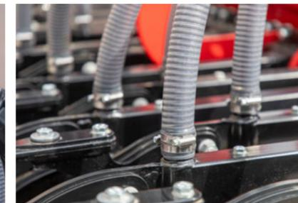
Optimierte Pneumatikverschlauchung und angesenkte Saatrohre
