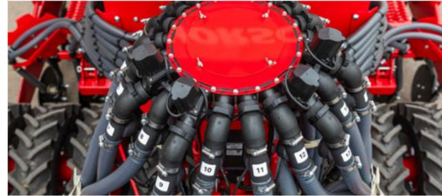
Überwachung des Pneumatikdurchflusses am Verteilerturm
