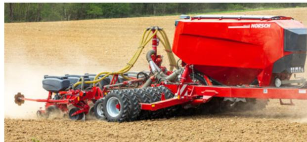
Hydraulisch vorgespannter Seitenpacker – Doppelreifen AS-Profil
