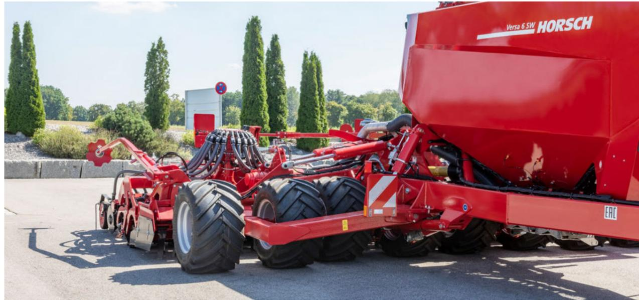
Hydraulisch vorgespannter Seitenpacker – Breitreifen
