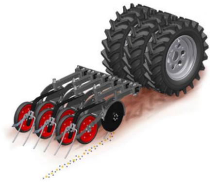
Doppeltank Grain & Fertiliser – Gemeinsame Ablage von zwei Komponenten über das TurboDisc Säschar
