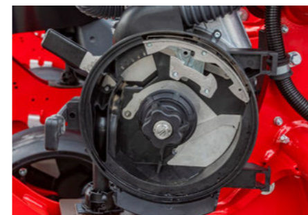
Der universelle Vereinzler muss nicht mehr eingestellt werden
