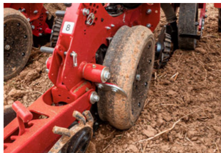
Das RID-Rad reduziert Bodenverdichtungen direkt am Säschlitz bei sehr harten oder Direktsaatbedingungen
