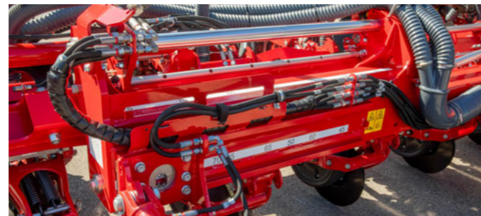
Absteckung des Anschlags der Flügel und Anpassung der Stützräder
