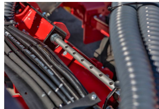
Absteckleiste zur Einstellung der Reihenweite
