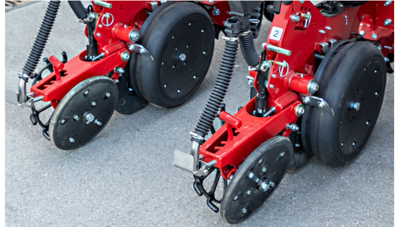
Mikrogranulateinheit an der Reihe mit beiden Applikationsstellen
