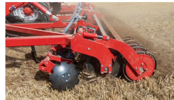
Hydraulisch vorgespannter Packer
