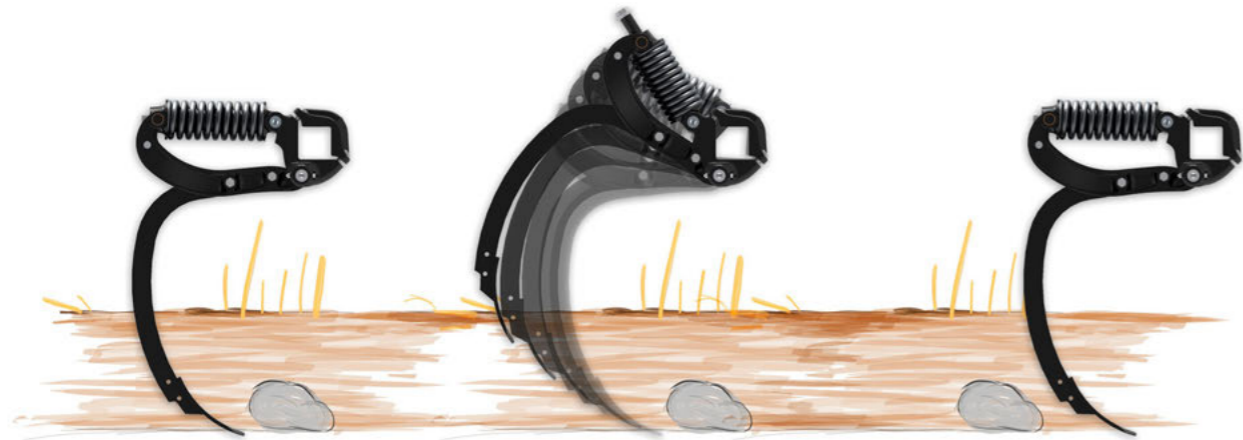
TerraGrip III - Auslösewirkung
