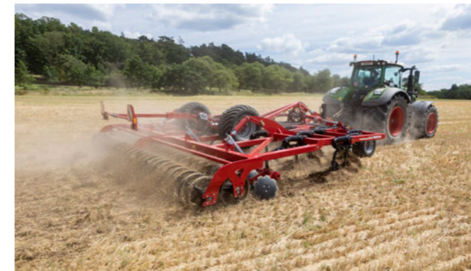
Starrer Packerrahmen mit Doppel RollPack Packer
