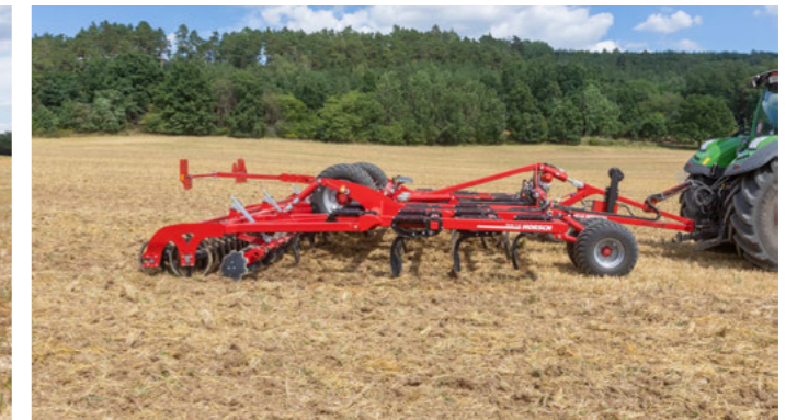
Starrer Packerrahmen mit DoppelPacker
