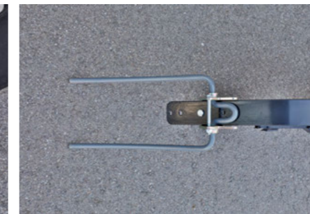
La herse de recouvrement équipant chaque élément semeur TurboDisc est guidée individuellement pour une meilleure efficacité
