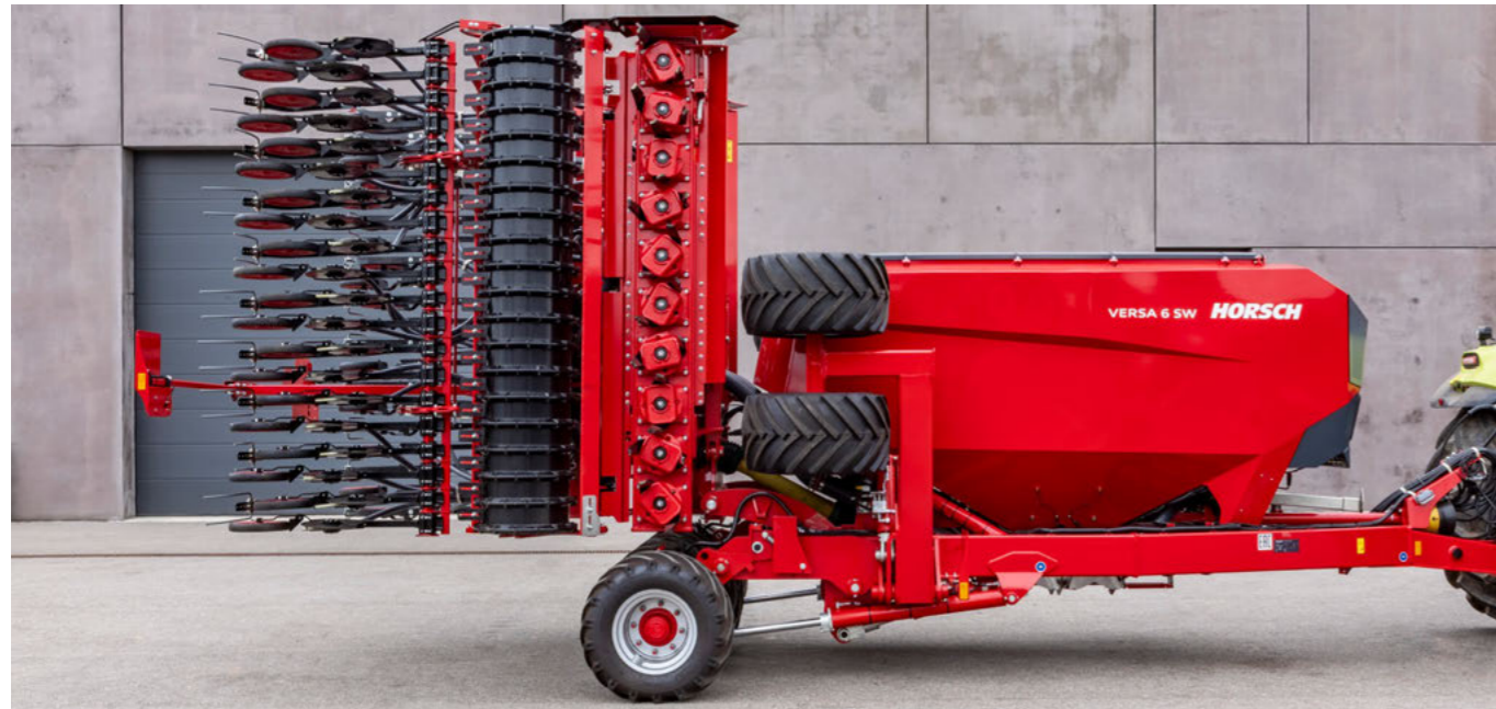
Essieu du Versa 6 SW en position de transport
