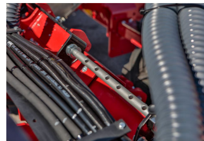
Barre de réglage pour gérer les différents interrangs
