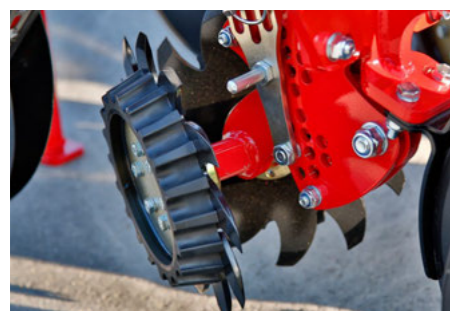
Etoile chasse-résidus en option, en position flottante avec contrôle de terrage
