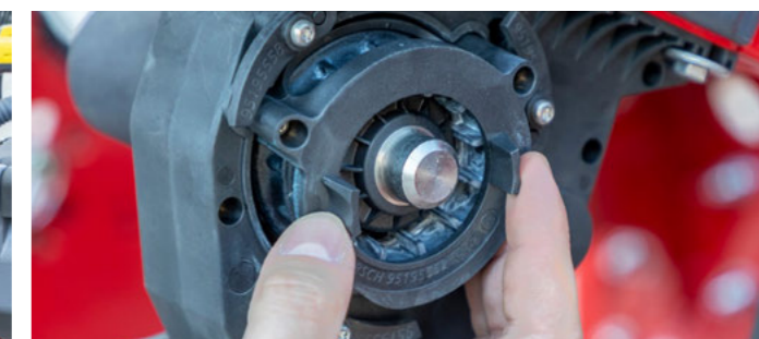
Doseur de microgranulé et rotor
