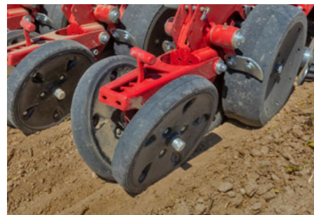
Roulette de fermeture large en V
