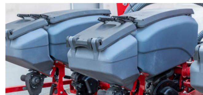
Microgranulateur d'une capacité de 20 l
