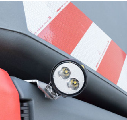
Phares de travail LED pour éclairage de la zone avant
