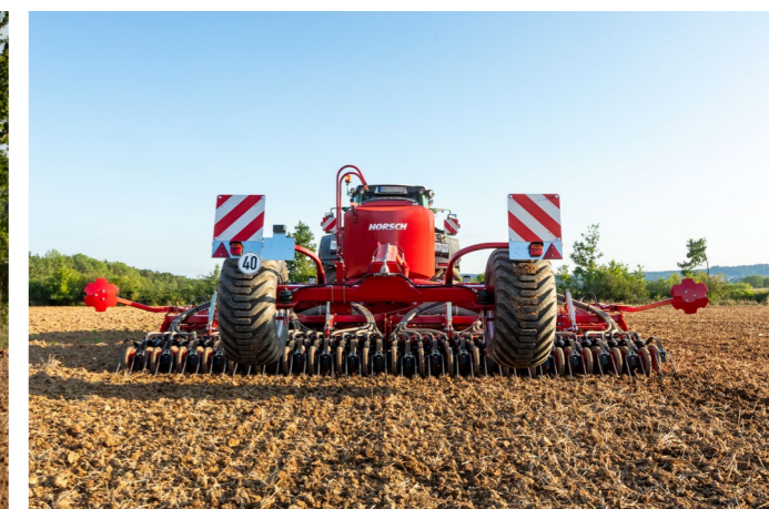
Cadre pendulaire intégré pour plus de précision – chaque demi-herse peut s'adapter aux dénivellations du sol
