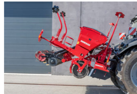
Vyšší světlá výška při silniční přepravě díky zatažení hydraulického válce
