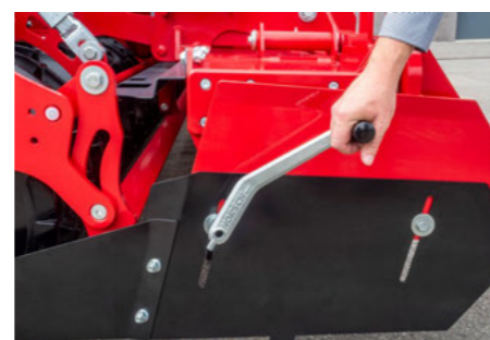
Nastavení bočních deflektorů univerzálním klíčem
