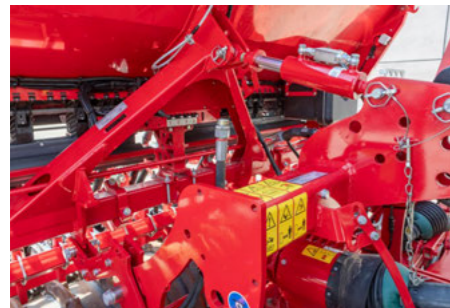
Hydraulické horní táhlo mezi rotačními bránami a Versa KR
