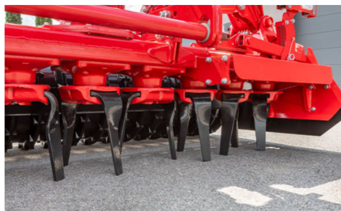
10 rotorů pro maximální průchodnost při pracovním záběru 3 m
