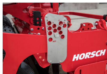
Dobře viditelné nastavení pracovní hloubky Versa SL pomocí zajišťovacího čepu
