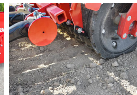
Pěch FarmFlex Snižuje tvorbu krusty díky pásovému zpětnému utužení
