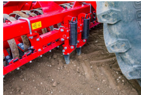
Odpružené radličky pro kypření kolejí traktoru
