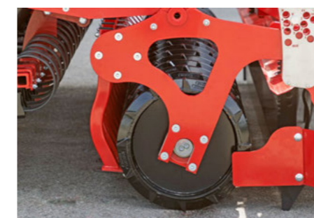
Trapézový prstencový pěch s průměrem 50 cm
