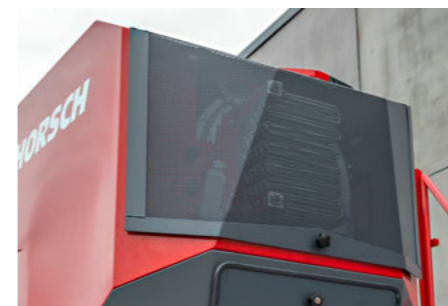
Olejový chladič na ventilátoru – ohřívá proud vzduchu v pneumatickém systému
