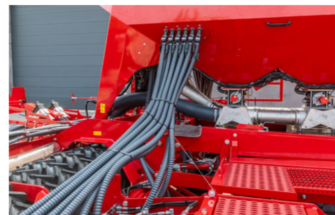
PPF dvoukomorový zásobník Pronto 9 DC s rozdělovacími hlavami v zásobníku
