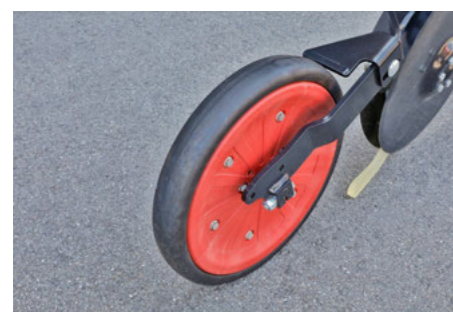
Vodící/přítlačné kolečko 5 cm široké – ideální pro středně těžké a těžké půdy
