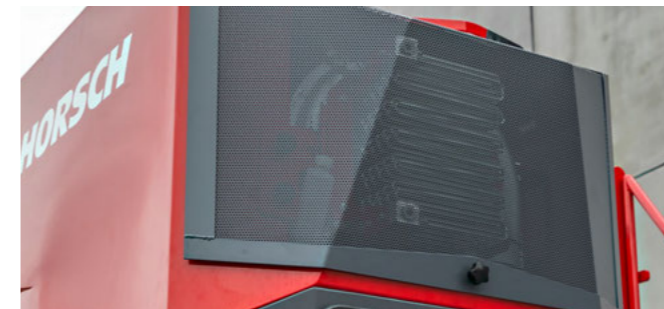
Olejový chladič na ventilátoru – ohřívá proud vzduchu v pneumatickém systému
