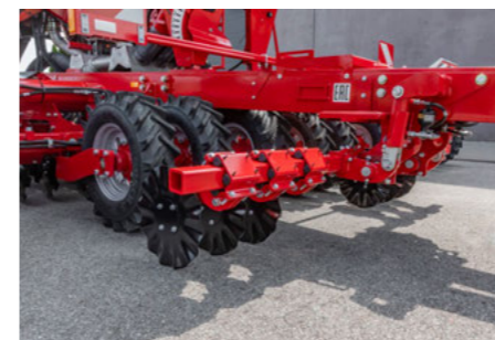
Kotoučové kypřiče narušují ztuhnutí ve stopách traktoru
