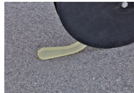
HORSCH Uniformer zajišťuje přesné uložení osiva.
