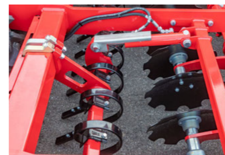
1-řadý Crossbar za DiscSystemem se dá hydraulicky nastavit.
