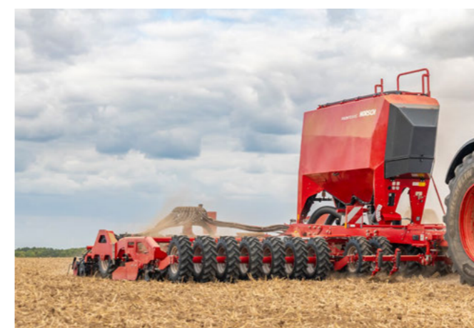
Radličky pro kypření stop, aby se znovu nakypřily stopy traktoru
