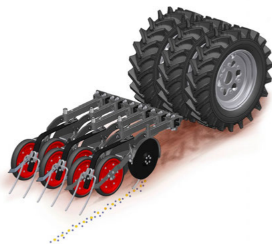
Dvoukomorový zásobník Grain & Fertiliser – společný výsev dvou komponent přes secí botku TurboDisc
