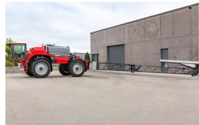
Volitelné: Hydraulická redukce záběru ramen 17/36 (m) na 30 m
