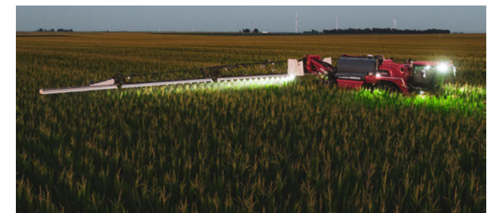
NightLight osvětlení kuželů trysek
