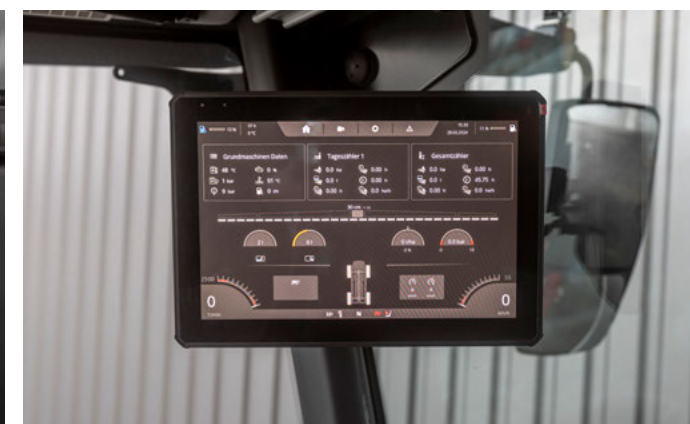
Sériový 12" displej s volně konfigurovatelným zobrazením na A-sloupku
