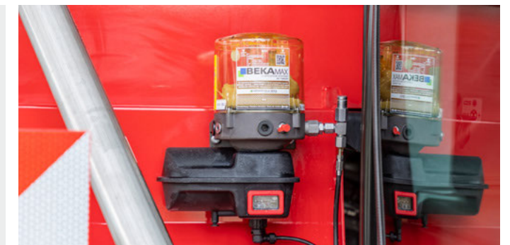
Nádrž centrálního mazacího systému
