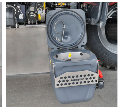
52 l nerezová přímichávací nádoba včetně přídavné míchací trysky
