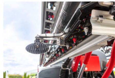
Kamera pro sledování trysek na NightLight držáku
