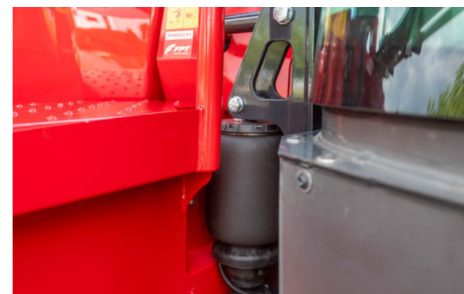
Pneumatické 4-bodové odpružení kabiny
