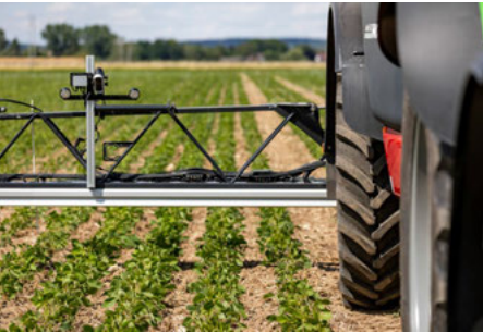
Vysoce přesné řízení taženého postřikovače s CultiCam
