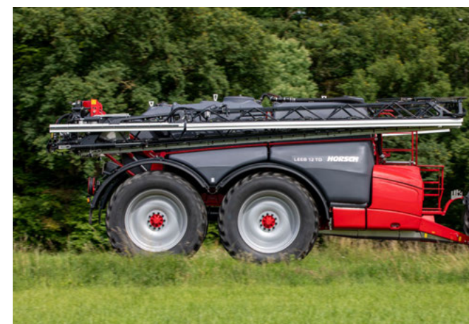
Klidná jízda díky tandemové nápravě a hydraulickému odpružení
