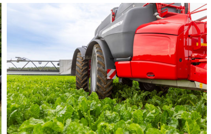
Aktivní řízení obou náprav integrované v softwaru stroje
