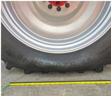
ATP Control – zvětšená styčná plocha při tlaku v pneumatikách 1,0 bar
