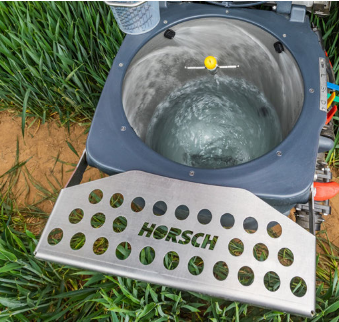
52 l nerezová přimíchávací nádoba včetně přídatné míchací trysky
