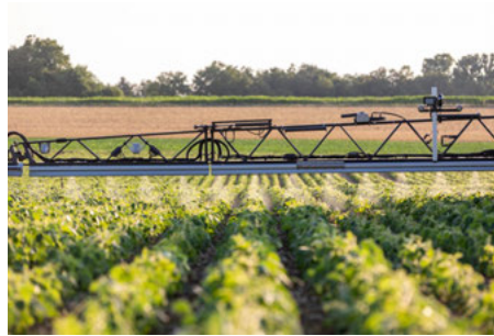
Efektivní pásová aplikace přímo na řádek rostlin s volitelným kamerovým řízením
