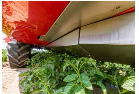
Hladké, nerezové opláštění spodní části
