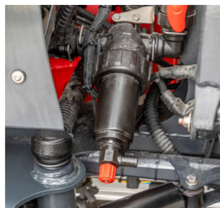
Druhý tlakový filtr na středové části ramen
