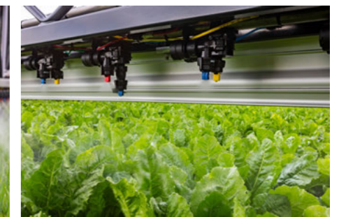
Pneumatické spínání trysek 2-2 s 3D aplikací
