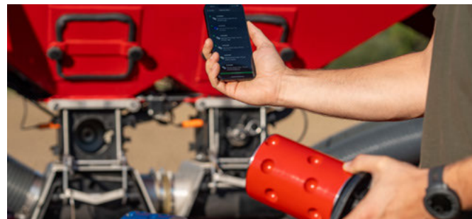
Aplikace HORSCH Assist s funkcí „Výběr válečku“ pomáhá při výběru optimálního dávkovacího válečku pro každé použití
