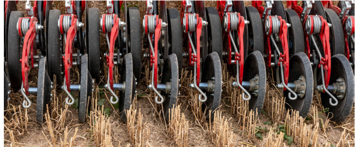
NarrowDisc jednokotoučové botky s roztečí řádků 20 cm
