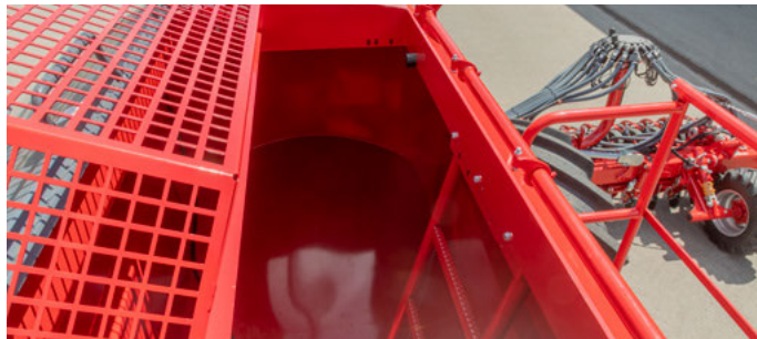
Otočný koš, takže se do zásobníku nedostávají žádné nečistoty
