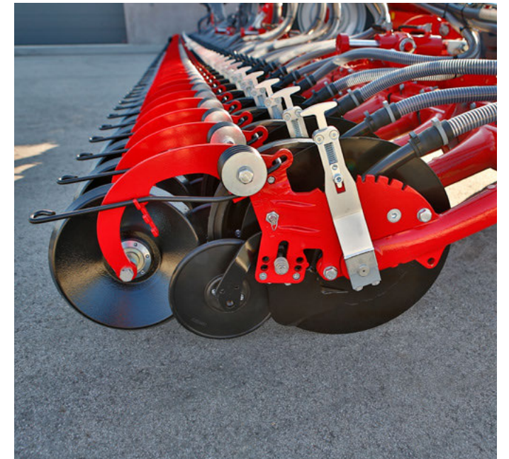
Perfektní fixace osiva díky pryžovému záchytnému kolečku
