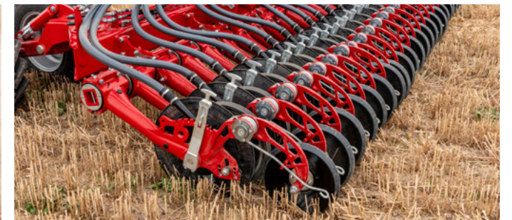
Jednokotoučová botka s individuálním hloubkovým vedením NarrowDisc
