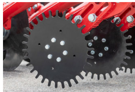
Čistící kotouč vhodný na slámu
