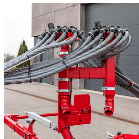
Możliwość wyłączania głowicy rozdzielacza, a co za tym idzie co drugiego rzędu siewnego
