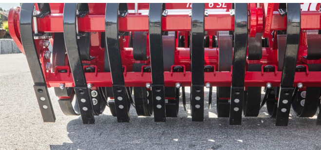
Szyna Crossbar, którą można hydraulicznie wsuwać i wysuwać, zapewnia dodatkowe wyrównywanie powierzchni przed wałem
