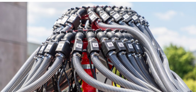
Kontrola przepływu nawozu i nasion zapewnia pełne monitorowanie węzów siewnych i nawozowych
