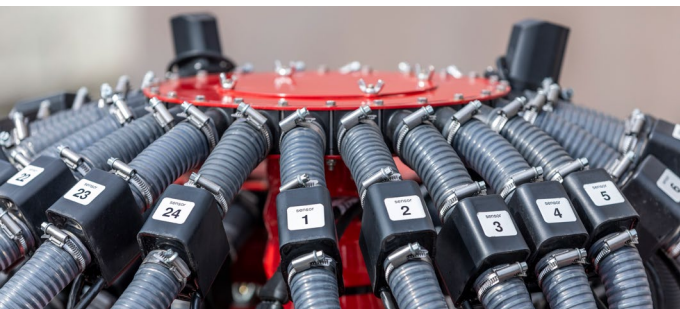
Monitorowanie przepływu powietrza w głowicy rozdzielczej.
