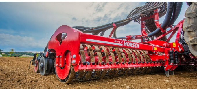
Wał RollFlex: głębokie zagęszczanie, kruszenie brył
