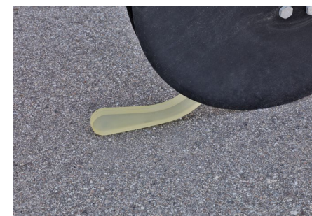
Wąs dociskowy HORSCH zapewnia precyzyjne unieruchomienie materiału siewnego
