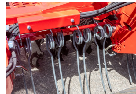
Zgrzebło jest umieszczone między talerzami DiscSystem a walem oponowym. Ustawienie odbywa się mechanicznie przy pomocy szablonu do otworów.
