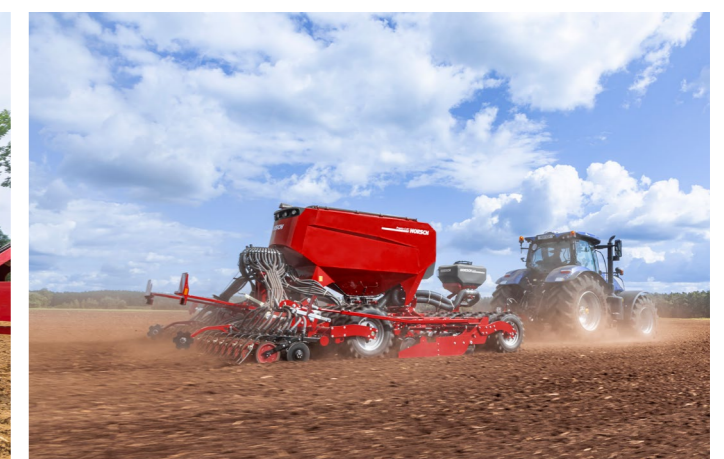
System podwójnych zbiorników PPF umożliwia oddzielne dozowanie i osadzanie dwóch składników na dwóch poziomach
