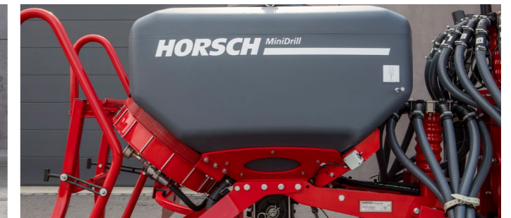
Samowystarczalne warianty MiniDrill posiadają własną dmuchawę, własny układ pneumatyczny i dodatkowy poziom umieszczania składnika
