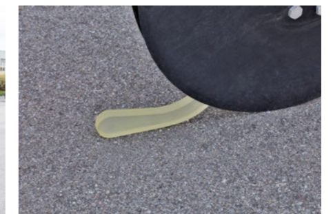
Wąż dociskowy HORSCH zapewnia precyzyjne unieruchomienie materiału siewnego
