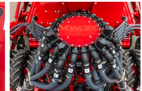
Monitorowanie przepływu powietrza w głowicy rozdzielczej.
