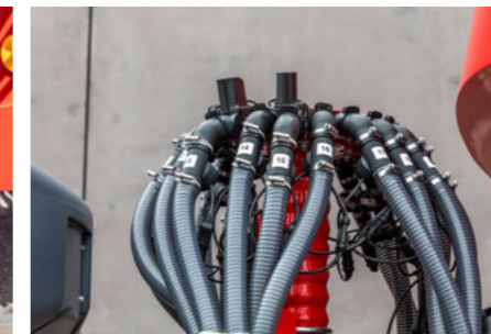
Kontrola przepływu nawozu i nasion zapewnia pełne monitorowanie węzłów siewnych i nawozowych
