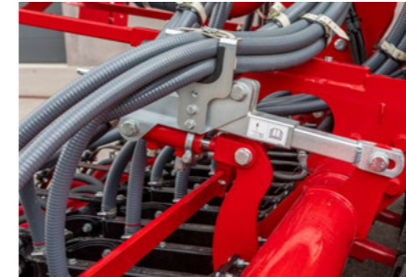
Nacisk redlic można zwiększyć za pomocą sterownika ciągnika
