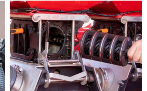
Walek – wkład do dozowania drobnych nasion
