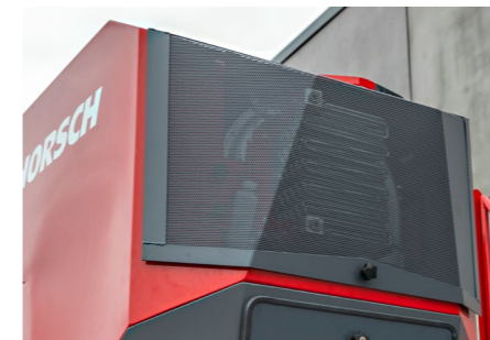
Chłodzenie oleju przy dmuchawie hydraulicznej – Podgrzewa przepływ powietrza w układzie pneumatycznym
