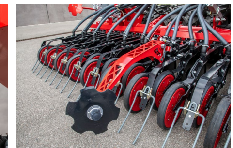
Agresywność znacznika przedwschodowego ustawia się za pomocą ogranicznika głębokości
