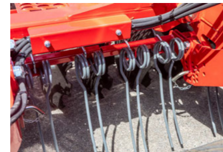
Zgrzebło jest umieszczone pomiędzy DiscSystem a walem oponowym. Ustawienie odbywa się mechanicznie przy pomocy szablonu otworów.
