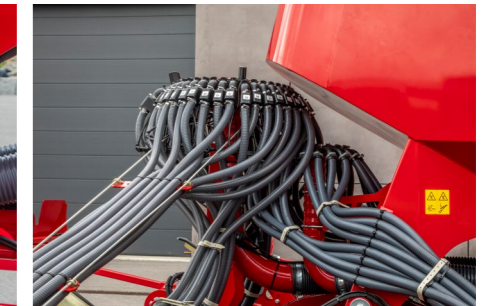
Zewnętrzna głowica rozdzielacza PPF zapewnia optymalny dostęp
