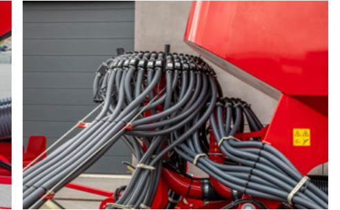
Zewnętrzna głowica rozdzielcza PPF zapewnia optymalny dostęp
