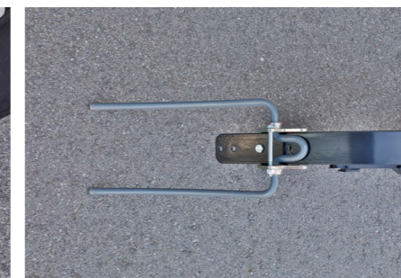
Proste zgrzeblo redlicy siewnej TurboDisc prowadzone jest pojedynczo w celu skutecznej uprawy gleby
