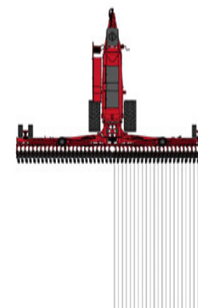
Oszczędność materiału siewnego dzięki wyłączeniu połowy szerokości roboczej
