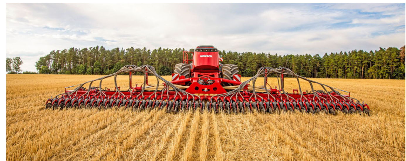
Cztery głowice rozdzielcze pozwalające na selektywne owężowanie.
