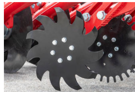
Gwiazdy czyszczące dla słomy kukurydzianej
