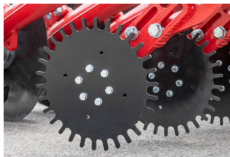
Gwiazdy czyszczące dla słomy zbożowej
