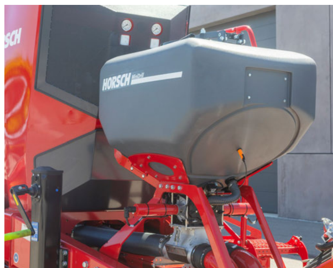
Możliwość wysiewu do czterech komponentów dzięki MiniDrill o pojemności 400 l
