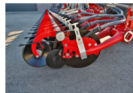
SingleDisc – doskonałe dopasowanie do powierzchni gleby dzięki kołu prowadzącemu na głębokości
