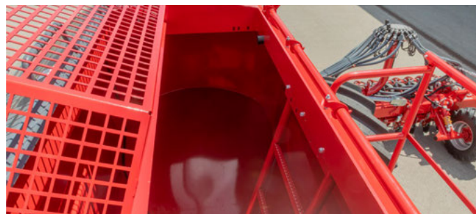
Kosz, który można odchylić, sprawia, że zanieczyszczenia nie dostają się do zbiornika
