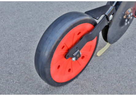
Сошник ParaDisc с прикатывающим роликом шириной 7 см
