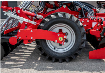
Легкость хода благодаря большому диаметру шин и отсутствию необходимости в чистиках
