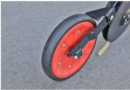
Прикатывающий ролик шириной 5 см идеально подходит для средних и тяжелых почв
