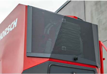
Масляный радиатор на гидравлическом компрессоре для нагрева воздушного потока в пневматической системе
