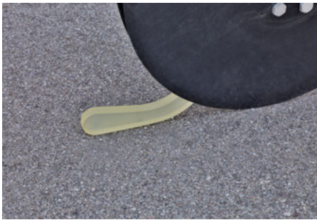
Семяукладчик HORSCH обеспечивает точную фиксацию семян.
