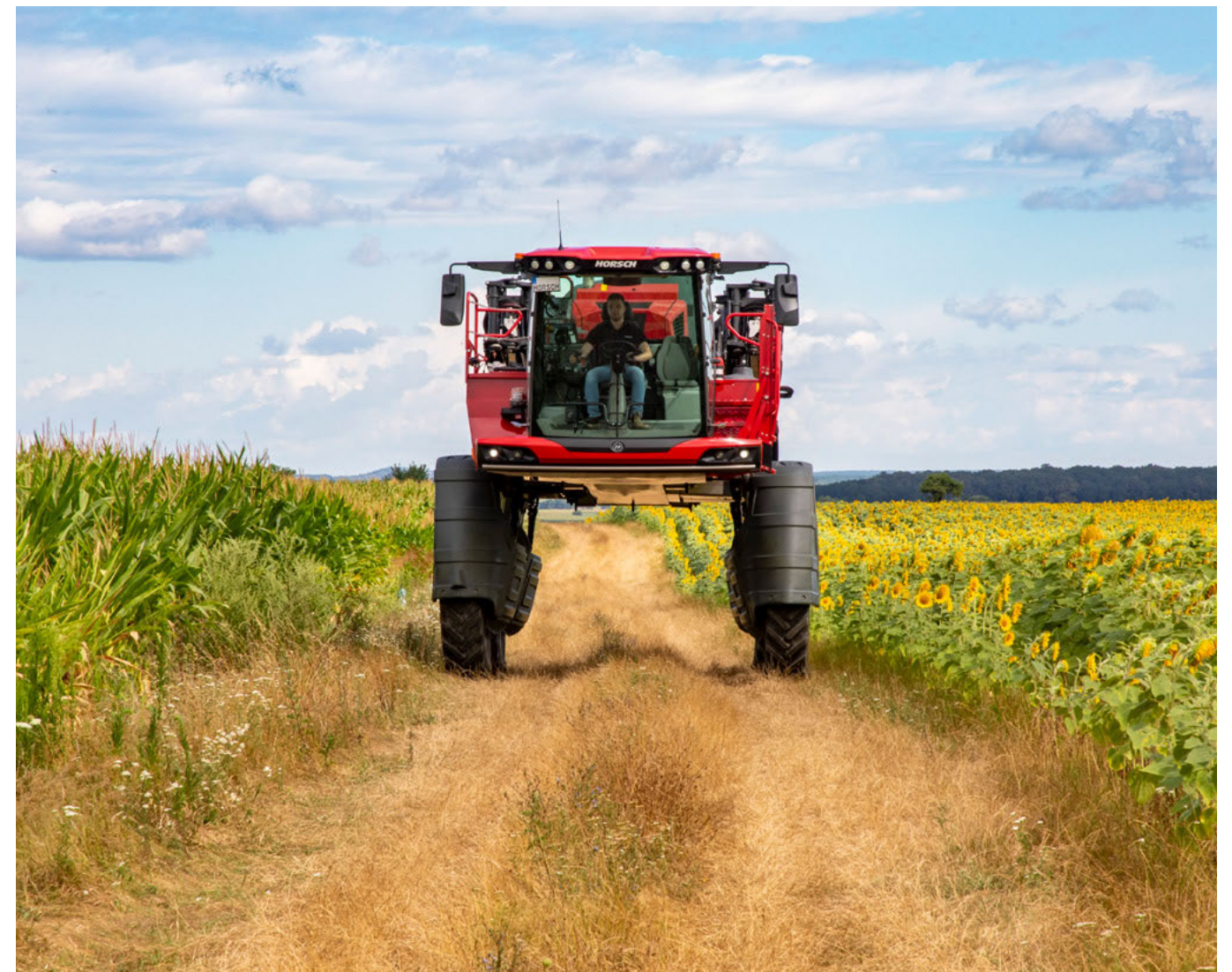
Максимальный дорожный просвет и гладкое днище для защиты растений
