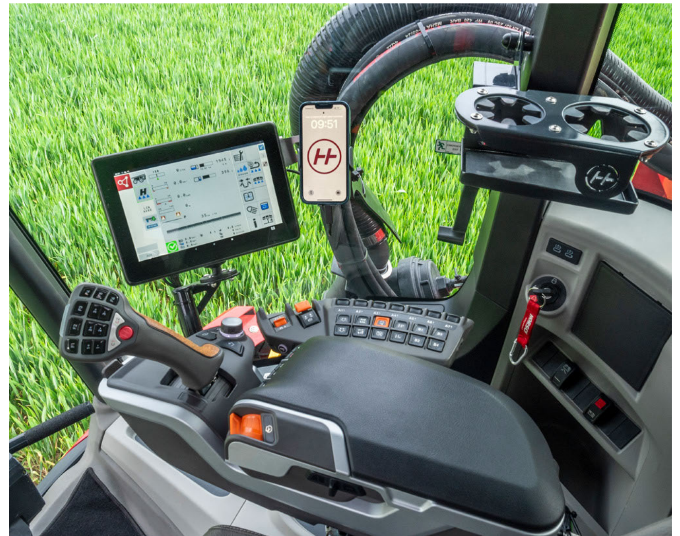
Комфортная просторная кабина с джойстиком, держателем для телефона и подстаканником
