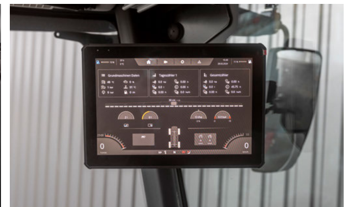
Стандартный 12-дюймовый дисплей на передней стойке с настраиваемым экраном
