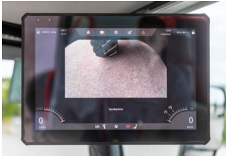
Изображение в высоком разрешении с камеры, направленной на колесо, на экране дисплея в кабине
