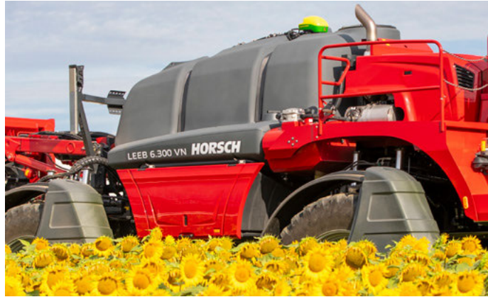
Максимальная защита растений благодаря использованию защитных кожухов колес для чувствительных культур
