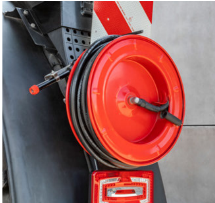
Шланг на специальной катушке для очистки внешних поверхностей
