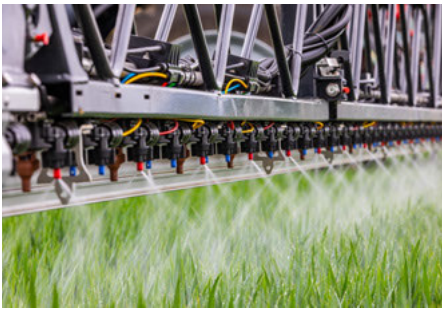
Расстояние между форсунками 25 см: больше возможностей, например, 3D-распыление.
