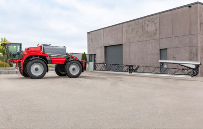
Опция: гидравлический механизм уменьшения ширины штанги 17/36 (м) до 30 м
