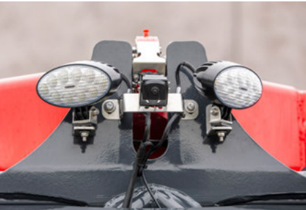
Камера заднего вида для контроля области позади транспортного средства
