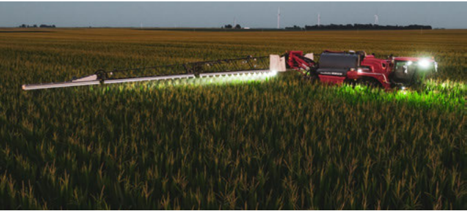
Фары NightLight для подсветки форсунок
