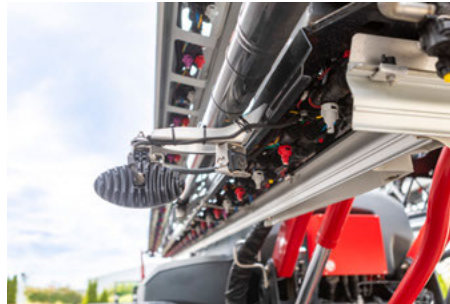
Камера для контроля форсунок на кронштейне системы NightLight
