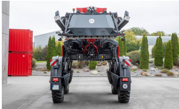
Бесступенчатая регулировка дорожного просвета
