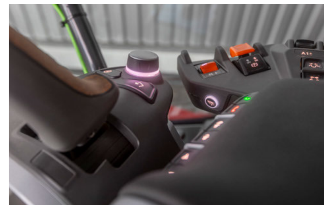
Уверенное управление дисплеем на передней стойке с помощью поворотного переключателя
