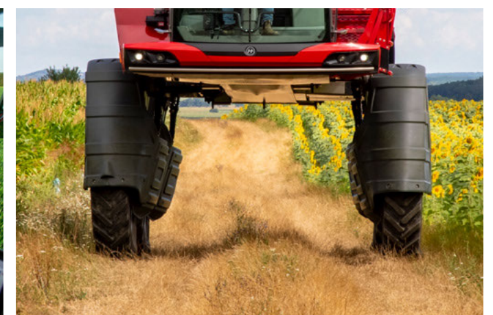
Максимальный дорожный просвет и гладкое днище для защиты растений
