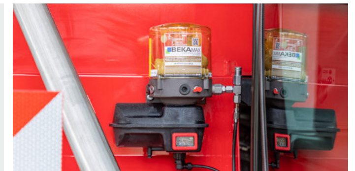
Бак централизованной системы смазки
