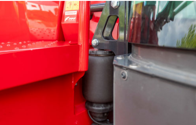
Пневматическая 4-точечная подвеска кабины
