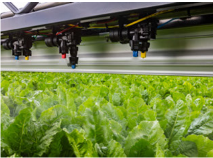
Пневматическое переключение форсунок в комбинации 2-2 с 3D-распылением
