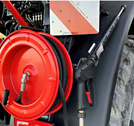
Гидравлическая мойка высокого давления
