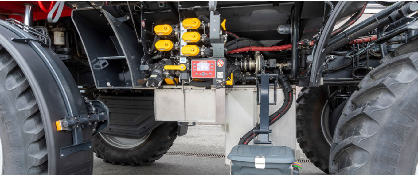
Система непрерывной очистки ContinuousCleaning-System Pro (CCS Pro)
