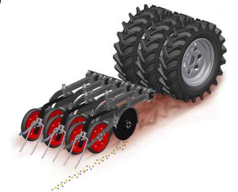
Zbiornik dwukomorowy, wersja Grain & Fertiliser – wspólne umieszczanie dwóch komponentów przy pomocy redlicy siewnej TurboDisc
