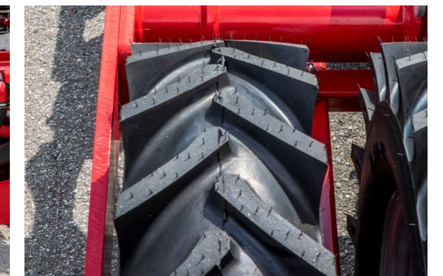
Prosty profil opon zwiększający wtórne zagęszczenie na krawędzi opony
