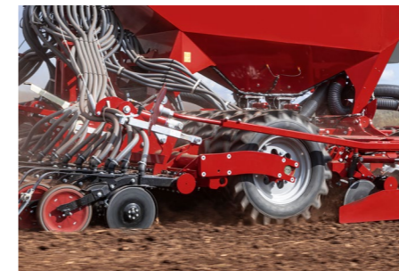
Efektywne wtórne zagęszczenie gleby pod nasionami zapewniające optymalne podsiąkanie wody
