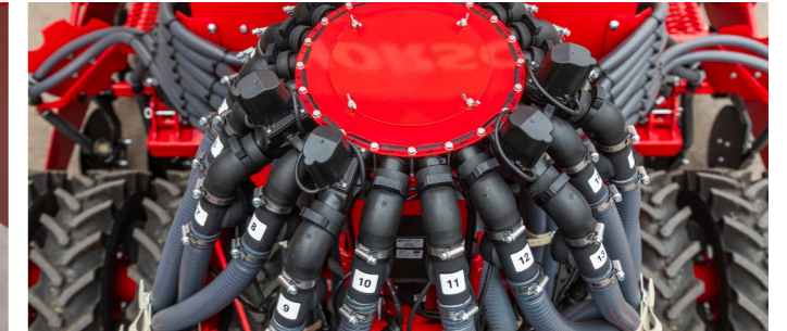
Monitorowanie przepływu powietrza w głowicy rozdzielczej.
