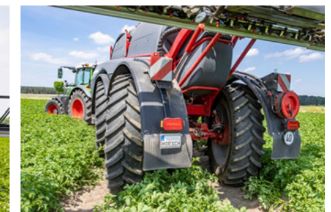
Aktywne kierowanie obydwoma osiami zintegrowane z oprogramowaniem maszyny
