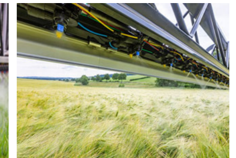
Pneumatyczne przełączanie dysz i szerokości częściowych
