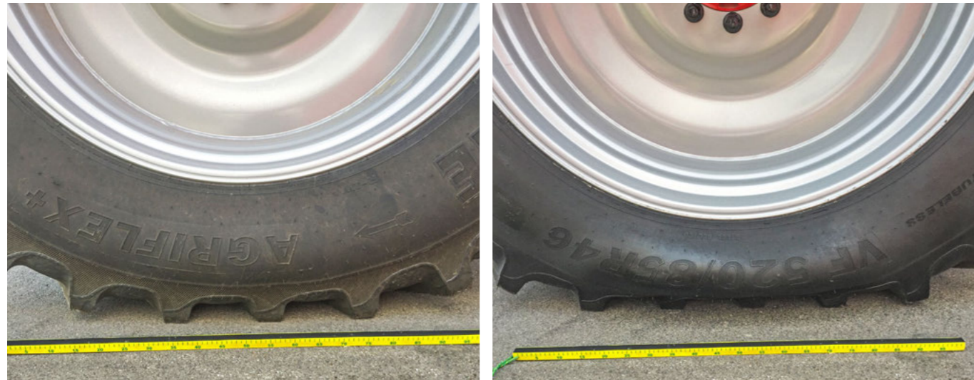
ATP Control – łatwa jazda przy ciśnieniu w oponach wynoszącym 2,3 bara
