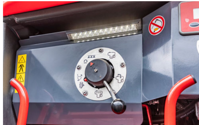
Oświetlenie pod blachą ochronną zapewnia pewną i bezpieczną pracę w ciemności
