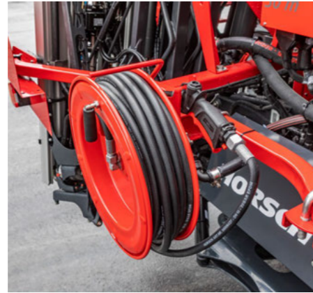
Wąż nawijany na bęben do mycia opryskiwacza z zewnątrz
