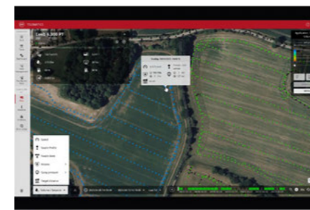
Przejrzystość jako czynnik sukcesu: dane dotyczące pozycji zawierające wszystkie istotne informacje, takie jak komunikaty o błędach, dawce wysiewu, stanie dysz lub docelowej odległości od pryskanej powierzchni
