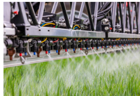
Rozdzielone dysze co 25 cm: więcej dysz, więcej opcji, na przykład aplikacja 3D
