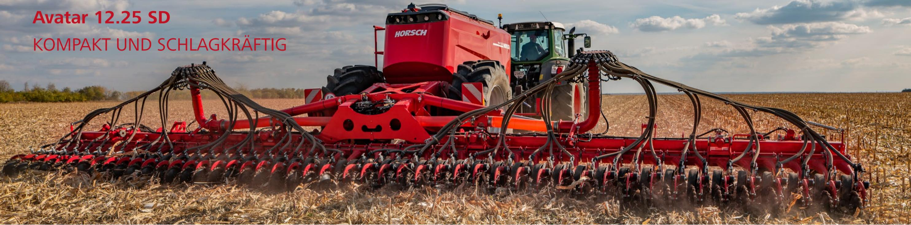
Der Grund, warum diese Maschinen am Markt so gut angenommen wird, ist recht simpel: Man kann die Avatar 12.25 SD laut Kundenerfahrungen mit einem 240 bis 250 PS starken Traktor fahren. Die Leichtzügigkeit dieser Maschinen ist auf verschiedene Aspekte zurückzuführen:
