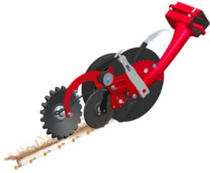
Für die Aussaat unter trockenen Bedingungen hat sich die Fangrolle in Kombination mit einer Sternschließrolle als optimale Lösung etabliert.
