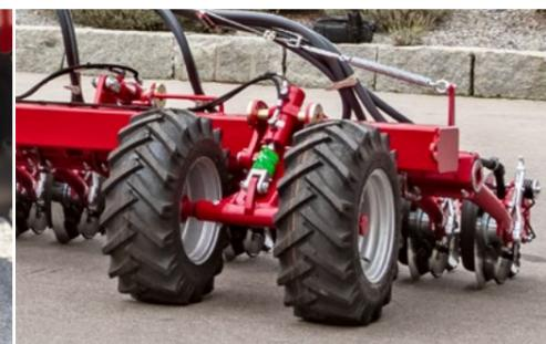
Zwillingsstützräder an den Flügeln reduzieren Spuren – je nach Arbeitsbreite optional oder Serie
