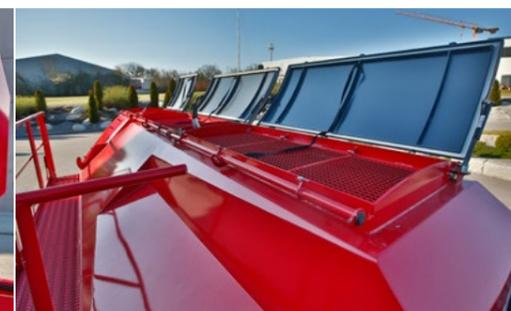
Großvolumige Tanköffnungen mit einfacher Verriegelung für kurze Befüllpausen
