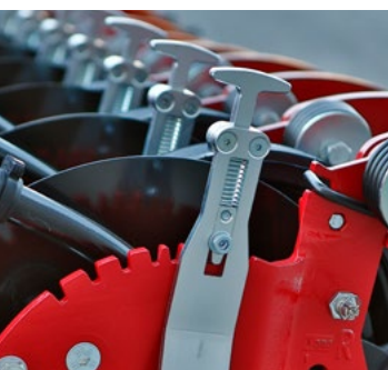
Werkzeuglose Saattiefenverstellung mit feiner Abstufung
