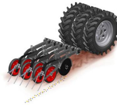
Doppeltank Grain & Fertiliser – Gemeinsame Ablage von zwei Komponenten über das TurboDisc Säschar
