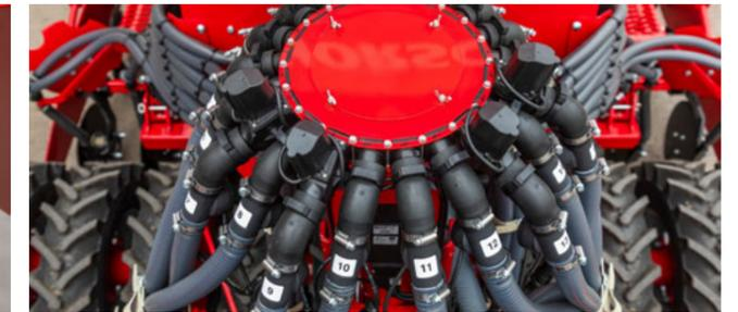
Überwachung des Pneumatikdurchflusses am Verteilerturm
