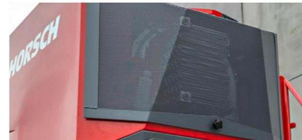
Ölkühlung am hydraulischen Gebläse – erwärmt den Luftstrom im Pneumatiksystem
