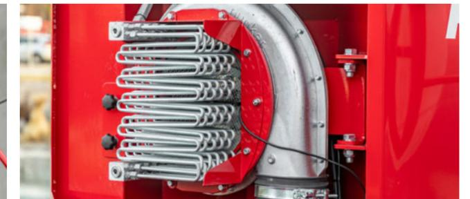
Senkt die Öltemperatur im System und entlastet den Ölkühler des Traktors
