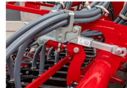
Über das Traktorsteuerggerät kann der Schardruck erhöht werden
