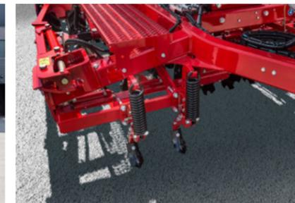
Gefederte Spurlockererzinken dienen der Lockerung von Bodenverdichtungen in der Traktorspur
