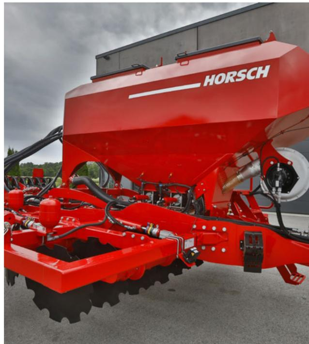
FertiProf avec cuve de 2 800 litres pour l'apport direct d'engrais en un seul passage
