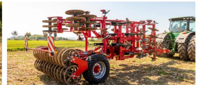
Position transport avec essieu revolver
