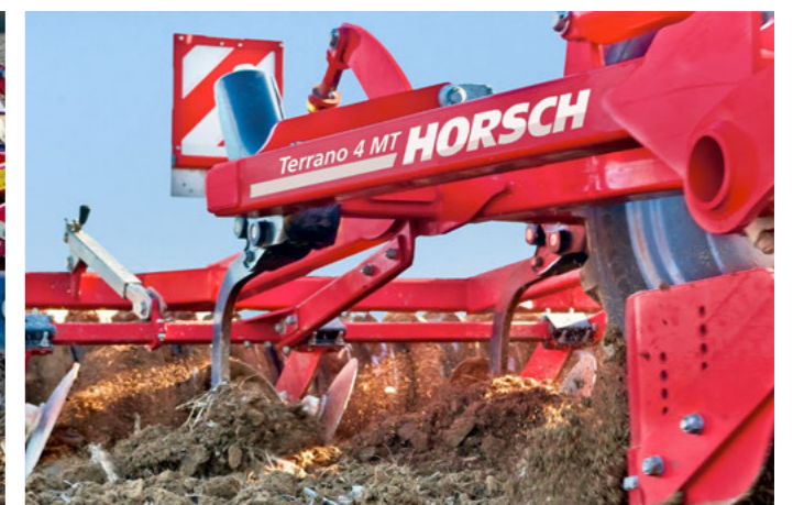
Ameublissement en profondeur avec perturbation minimale du sol grâce aux pointes LD
