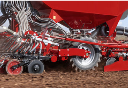
Ré-appui efficace sous l'horizon de semis pour une remontée de l'humidité par capillarité
