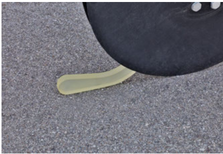
L’uniformer HORSCH en téflon de l’élément TurboDisc garantit une dépose précise de la semence
