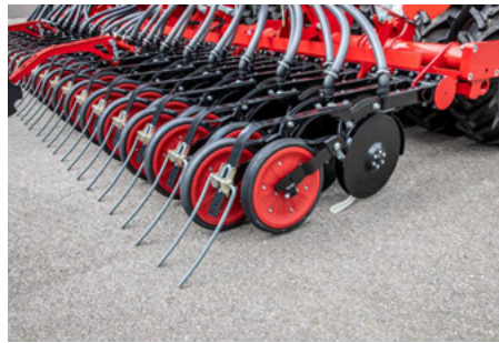
Elément semeur HORSCH TurboDisc
