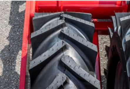
Le profil agraire de la roue accroît le ré-appui dans la zone de bordure
