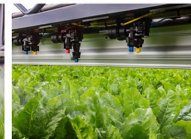
Commutation de buse pneumatique 2-2 avec application 3-D
