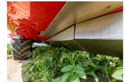
Carénage sous le châssis parfaitement lisse en acier inoxydable
