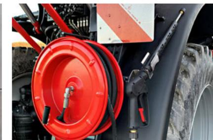
Nettoyeur haute pression à entraînement hydraulique
