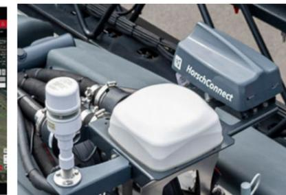
Station météorologique intégrée et interconnectée avec les fonctions de HorschConnect et du GPS pour une adaptation optimale aux conditions météorologiques en place.
