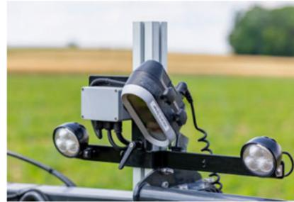
Direction par caméra CultiCam avec pack de phares pour travaux en conditions d'éclairage difficiles
