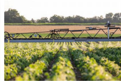
Positionnement efficace de la buse directement au-dessus des rangs avec guidage par caméra en option.
