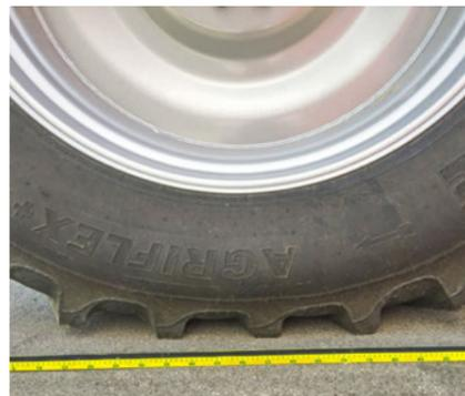
ATP Control – passage allégé avec une pression des pneus de 2,3 bars
