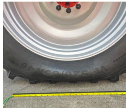
ATP Control- surface de contact accrue à une pression de 1,0 bar
