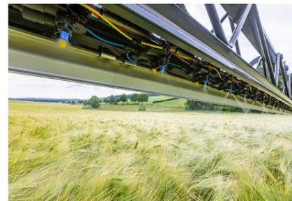
Ouverture pneumatique des buses et des tronçons
