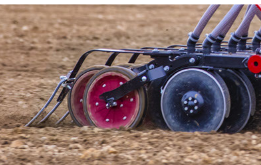
TurboDisc Säschar der dritten Generation ermöglicht eine präzise Saatgutablage
