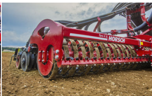
RollFlex Packer übernimmt die Tiefenführung und produziert Feinerde
