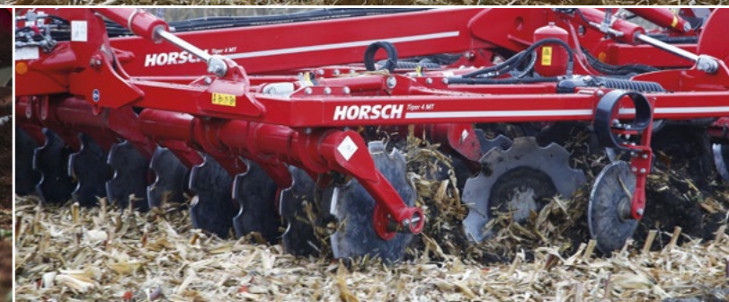
DiscSystem pesante Disposizione su 2 file, diametro dei dischi 68 cm, distanza tra i dischi 40 cm, dischi dentellati con sospensione singola
