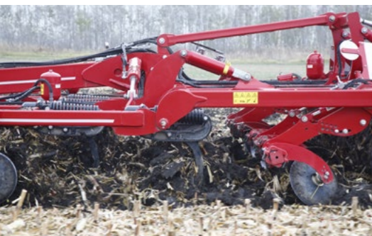
TerraGrip Ulteriore miscelazione e dissodamento tramite due file di denti
