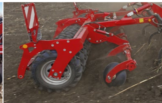
Dischi di livellamento Livellamento uniforme a monte del packer con pneumatici in gomma
