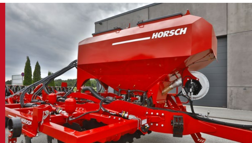
DiscSystem pesante Disposizione su 2 file, diametro dei dischi 68 cm, distanza tra i dischi 40 cm, dischi dentellati con sospensione singola
