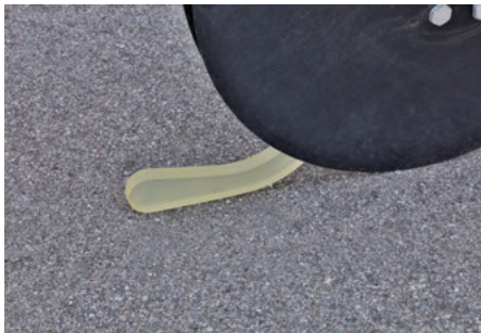
L'HORSCH Uniformer garantisce un fissaggio preciso del seme
