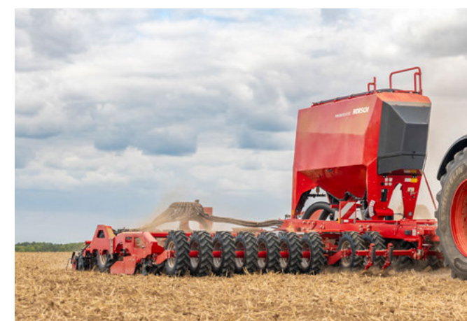
Denti rompitraccia per eliminare il calpestino del trattore
