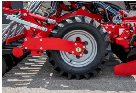
Bassa richiesta di potenza grazie al grande diametro degli pneumatici e all'assenza di raschiatori
