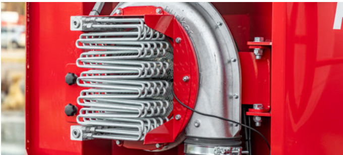
Abbassa la temperatura dell'olio nel sistema e alleggerisce il radiatore dell'olio del trattore
