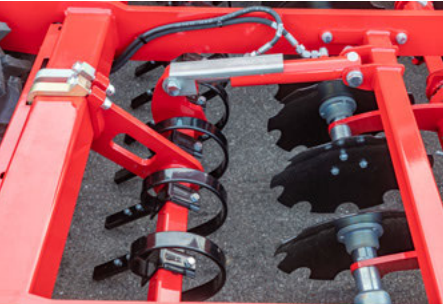
Il Crossbar a 1 fila direttamente dietro il DiscSystem è regolabile idraulicamente
