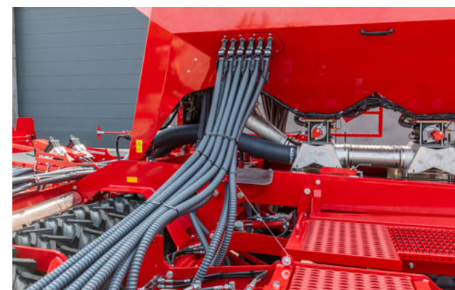
PPF serbatoio doppio Pronto 9 DC con funghi di distribuzione nel serbatoio
