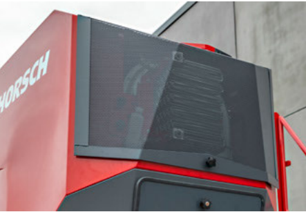
Raffreddamento dell’olio sul ventilatore idraulico – riscalda il flusso d’aria nel sistema pneumatico
