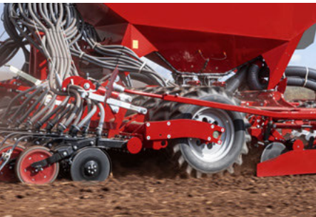
Consolidamento efficace sotto il livello di semina per un'ottimale conduzione dell'acqua al seme
