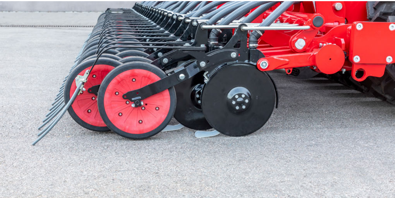
ParaDisc coltro di semina – fino a 150 kg di pressione del coltro possibile
