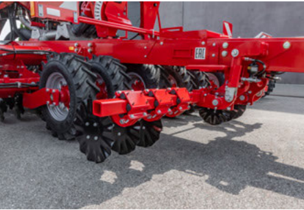
I dischi rompitraccia allentano le compattazioni nelle tracce del trattore
