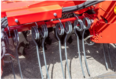
L’erpice è posizionato tra il DiscSystem e il rullo pneumatico. La regolazione avviene meccanicamente tramite uno schema di fori.
