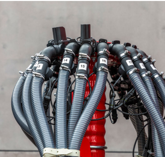
Controllo del flusso di fertilizzante e seme – per un monitoraggio continuo dei tubi di semina e fertilizzazione
